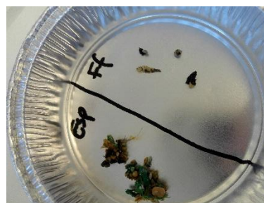
Figur 17. Plastmateriale hentet fra Romerike biogassanlegg. Til nederst i bildet etter sentrifuge plast (ESP) og øverst i bildet Romerike biogassanlegg fast (RBFF).
