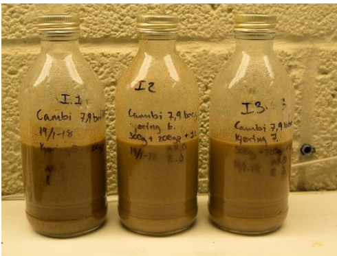
Figur 13. Prøver av substrat inkubert ved 38°C satt til fermentering og biogassproduksjon. Prøve C511F1, C612F2 og C713F3.
