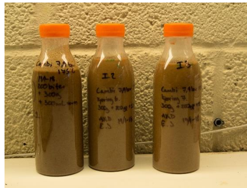
Figur 14. Prøver av substrat tatt ut etter THP Cambi for lagring ved 4°C. Prøve C511, C612 og C713.
