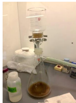
Figur 8. Filtertrakt med vakuumpumpe drevet filtrering
