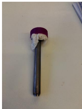
Figur 10. Verktøy benyttet for uthulling av plastmaterialer fra matavfall posen
