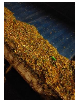
Figur 4. Plastmaterialer separert etter sentrifuge ved Romerike biogassanlegg.
