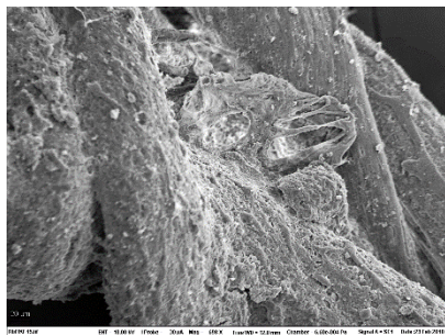
Figur 38. Innzoomet bilde på plastbiten til høyre på bilde 37. Bildebredde målt til 426,667µm.
