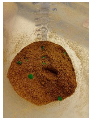
Figur 11. Syntetisk matavfall tilsatt plastmateriale benyttet i skudd 6 i THP.
