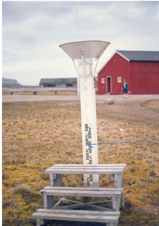
Figur 3.5: Den manuelle nedbørsmåleren i Ny-Ålesund. Rundt den sylinderformede oppsamlingsbøtten er det en Nipher-vindskjerm. Modifisert etter foto: Meteorologisk Institutt. Modifisert og gjengitt med tillatelse fra Meteorologisk Institutt. Hentet fra [67].
