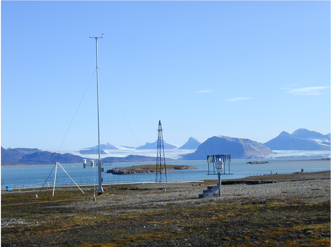
Figur 3.6: Den automatiske målerstasjonen i Ny-Ålesund. Modifisert etter foto: Ragnar Brækkan. Modifisert og gjengitt med tillatelse fra Meteorologisk Institutt. Hentet fra [12].
