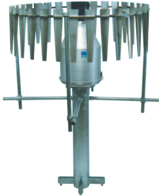
Figur 2.3: Automatisk nedbørsmåler (Geonor T200-B) av typen som brukes i Ny-Ålesund. Av bildet observeres det tydelig en Alter-vindskjerm som omkranser beholderen. Foto: Geonor AS. Gjengitt med tillatelse fra Geonor AS. Hentet fra [22].
