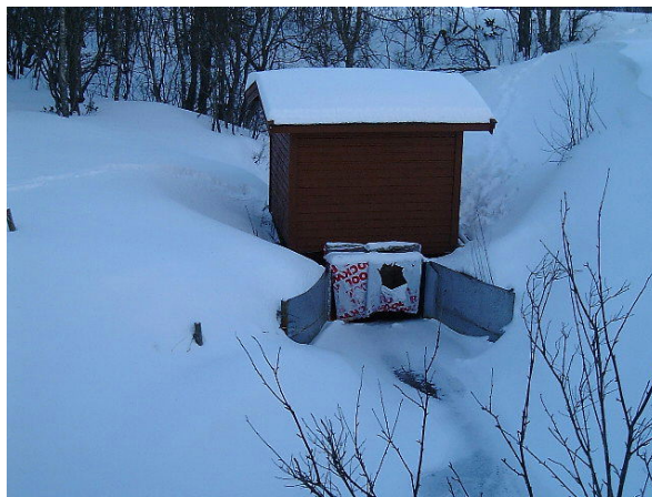
Oppstrøms målestasjonen i Naurstadfeltet. Vannføringsproporsjonale prøver blir her tatt ut ved hjelp av en prøvetaker, MJK type 780 (Foto: P. M. Hansen).
