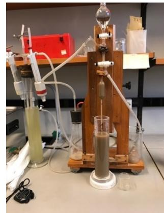
Figur 10: Pipettevogn med utstyr til pipettemetoden i kornfordelingsanalysen (foto: Stine Hagen)
