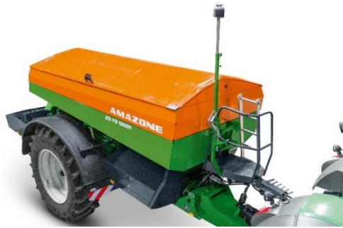
Figur 4.4-2: AMAZON WindControl. Sonisk vindmåler for automatisk spredningsjustering [63].
