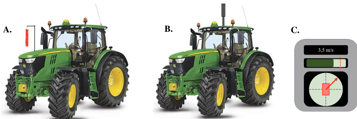
Figur 14.1-4: A. Illustrasjon av komplett vimpelløsning plassert på panseret. B. Illustrasjon av sonisk vindmåler eller anemometer fremstilt som en sort boks med plassering på kjøretøyets tak. C. Illustrasjon av foretrukket displayløsning for dataoverføring.
