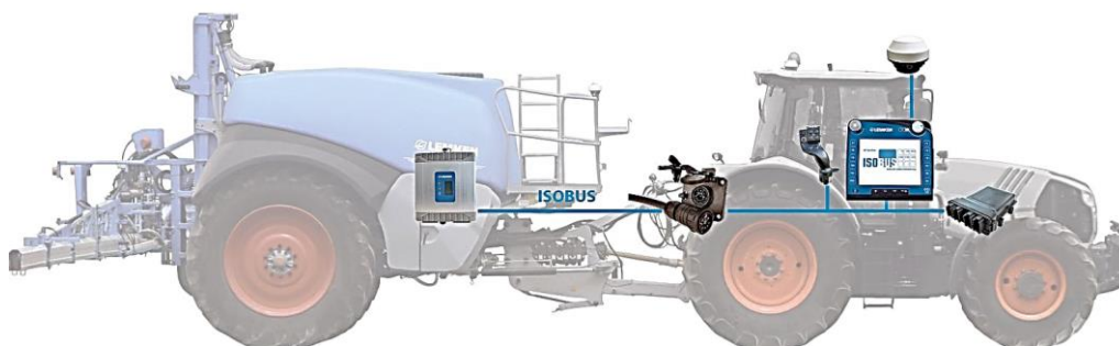
Figur 4.5-1: Forenklet illustrasjon av ISOBUS sin sammenkobling av traktor og sprøyte [66].
