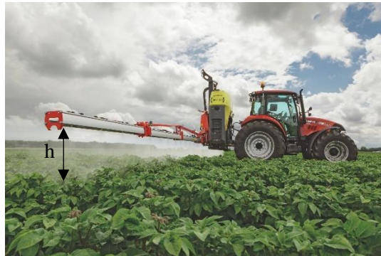
Figur 1.1-2: Illustrasjon av dysehøyde på åkersprøyte. h representerer høyden. [18]
