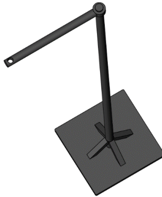
Figur 8.1-4: Illustrasjon av endelig design for vimpelstativet, som utgjør den forenklede, alternative løsningen.
