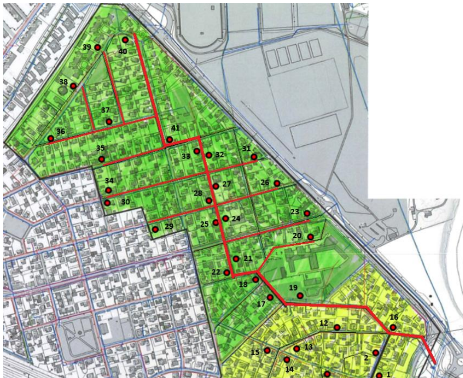
Figur 30: Fet rød linje viser hovedledningen i sone 2. Tynn rød strek viser ledninger som kobler seg inn på hovedledningen.
