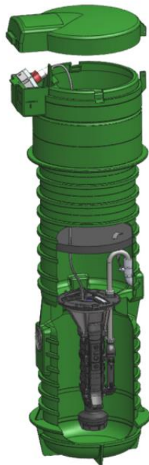
Figur 6: Eksempel på en skruepumpe med kverne . (Skandinavisk kommunalteknikk, u.d.)
