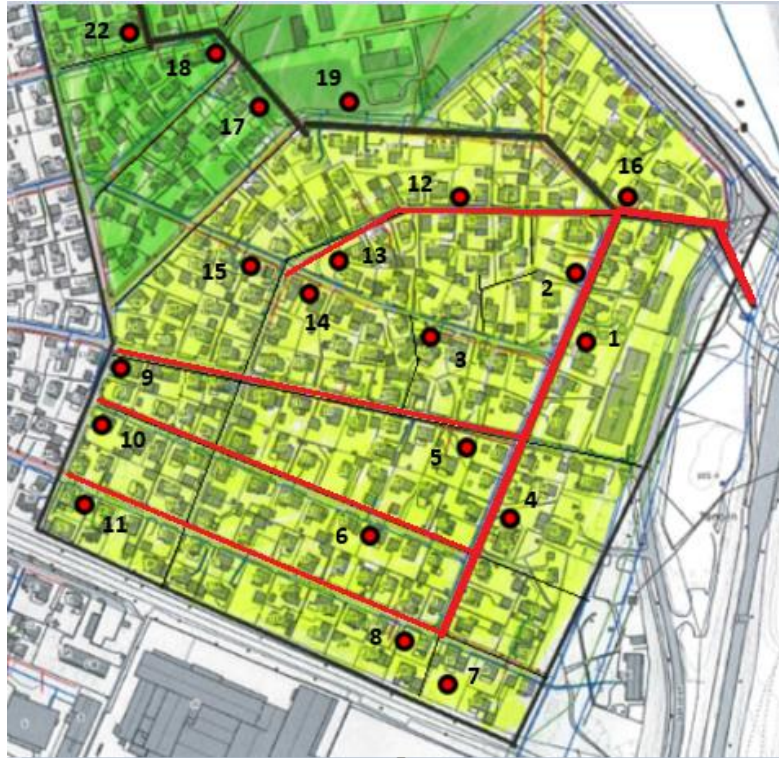
Figur 29: Fet rød linje viser hovedledningen i sone 1. Tynn rød strek viser ledninger som kobler seg inn på hovedledningen.
