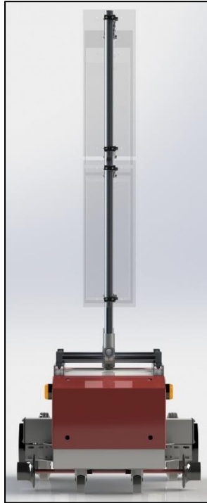
Figur 10.26: UV-verktøy for agurkkulturer med lysmoduler påmontert veksthusrobot.
