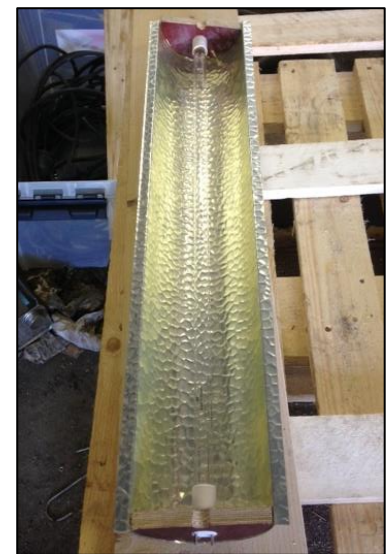
Figur 7.8: Reflektor benyttet i forsøkene. Som bildet viser, er overflaten hamret. Materialet er MIRO 9.
