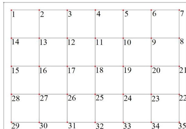
Figur 7.3: Illustrasjon av platen med påtegnet rutenett. De 35 krysningsspunktene mellom de 15*15cm kvadratene, illustrert i rødt, angir plasseringen av sensoren gjennom hvert forsøk.
