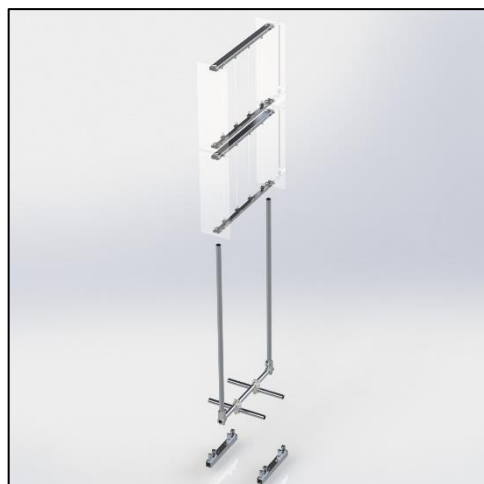
Figur 10.31: Rammen til UV-verktøy for agurk-kulturer er illustrert i senter. Hurtigfestet er i bunn og lysmoduler øverst.
