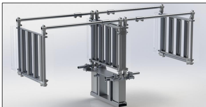
Figur 10.24: Illustrasjon av UV-verktøy. Løfteplattformen, bestående av en konstruksjon som bærer løftesøylene, har innfestingspunkter som festes til hurtigfestet. Rammekonstruksjonen som bærer lysmodulene er videre festet til løfteplattformen via friksjonskoblinger.
