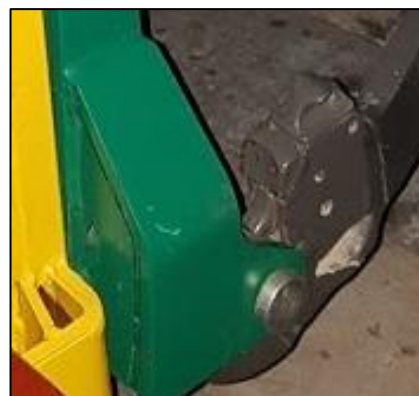
Figur 4.23: Fanghakekobling med påmontert redskap. Kulen er fastlåst til trekkarm med låsetapp og har en gjennomgående bolt som fester den til redskapen.
