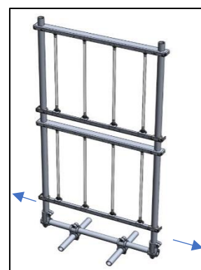
Figur 8.13: Rammekonstruksjon med påmontert lysmodul for bestråling av agurkplanter. Med friksjonskoblinger kan rammen justeres i lengde (vist med piler).
