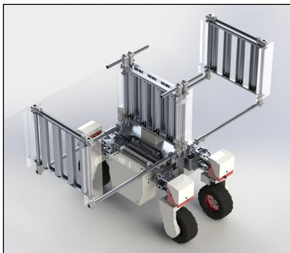
Figur 10.22: UV-verktøy for jordbærplanter som vokser i kasser hengende fra taket. Oppsettet er modifisert for bred avstand mellom lys og plante.
