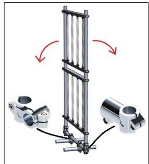
Figur 9.25: UV-verktøy for agurk. Venstre: krysskobling. Høyre: vinkelkobling.
