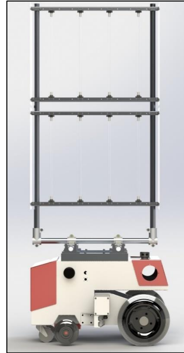
Figur 10.27: UV-verktøy for agurkkulturer montert til veksthusrobot via hurtigfestet.
