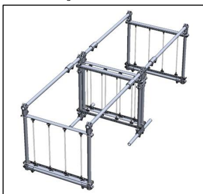
Figur 8.11: Rammekonstruksjon med påmonterte lysmoduler for bestråling av table-top jordbær stående fra underlaget. Bruk av friksjonskoblinger gjør det mulig med individuelle justeringsmuligheter.
