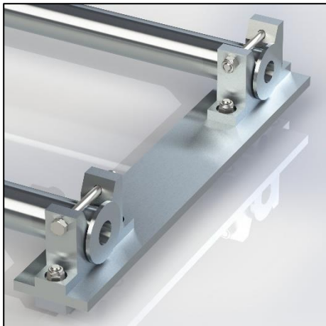
Figur 10.37: Faghakekoblingene med fastmontert verktøydel. Utformingen tilrettelegger for selvsentrering og låses fast med låsebolt. Fastlåsing kan i fremtiden automatiseres ved bruk av aktuatorer eller solenoider.
