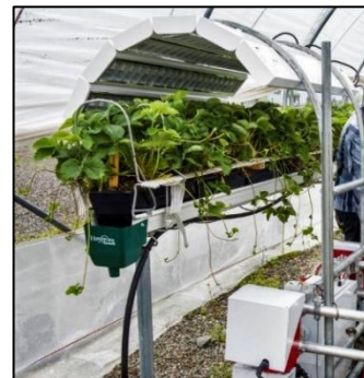
Figur 6.1: Den første versjonen av UV-verktøyet under testing i plasttunnel hos Simen Myhre. [Saga Robotics]
