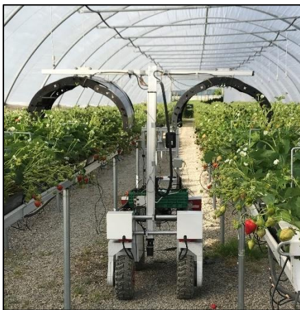
Figur 1.3: Smal versjon av Thorvald II påmontert UV-bestrålingsverktøy under testing hos Norske Jordbær DA v/ Simen Myhre. [Saga Robotics]
