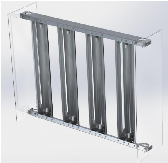
Figur 10.28: Lysmodul med transparente beskyttelsesplater av polykarbonat festet til hver ende. Lysmodulen har påmonterte reflektorer for hvert av de fire lysstoffrørene. Lysrørholderne har kapslingsgrad IP67. Lysstoffrørenes ballast er plassert i egne innkapslinger.
