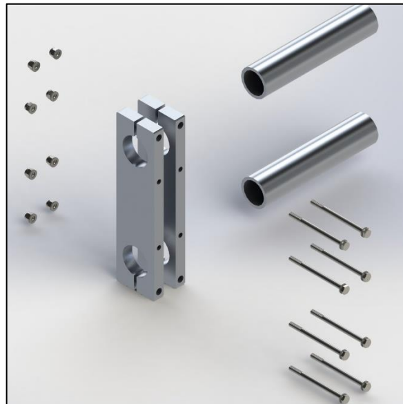
Figur 10.15: Eksplosjonstegningen viser komponentene som utgjør fremre brakett. Rørprofilene har diameter 40 mm og festes til robotens fremre hjørnepunkter. Braketten festes til bærerammen via fire M6 bolter. Friksjonskoblingen strammes med to M6 bolter øverst og nederst som illustrert i figuren.
