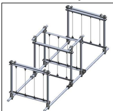
Figur 8.12: Rammekonstruksjon med påmonterte lysmoduler for bestråling av jordbærplanter hengende fra taket. Bruk av friksjonskoblinger gir justeringsmuligheter.
