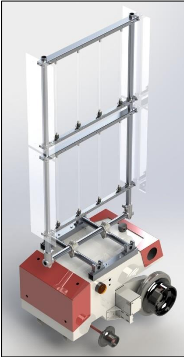
Figur 10.25: UV-verktøy for agurkkulturer påmontert veksthusrobot. Roboten beveger seg på skinner.
