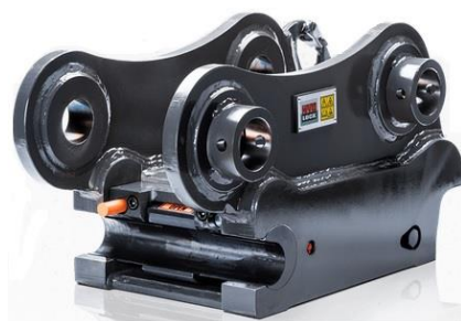
Figur 4.24: SMP HardLock hurtigfeste. Figuren viser fremre lås hvor den eksentrisk roterende delen låser fremre aksel. Låsekilen som låser bakakselen befinner seg på motstående side [53].
