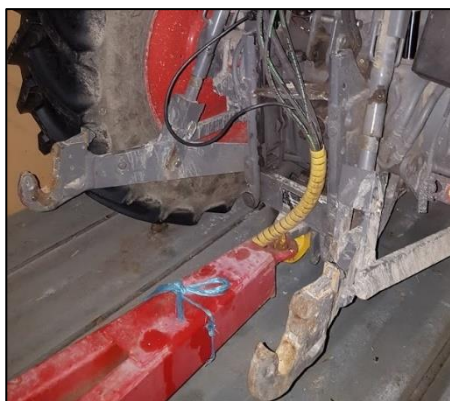
Figur 4.22: De to trekkstengene er utstyrt med fanghakekoblinger på enden. De U-formede koblingene gir rom for kulen som skal låses fast.
