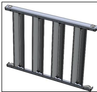
Figur 8.17: Sammensatt lysmodul med reflektorer. Reflektorene boltes fast individuelt og kan dermed enkelt monteres av og på.
