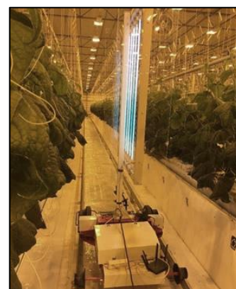
Figur 6.3: UV-verktøyet under testing på agurkplanter hos Kristian Guren. [Saga Robotics]
