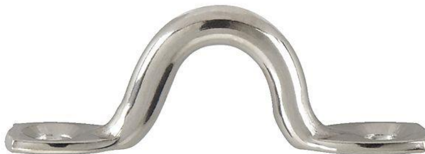
Figur 8.4.1: Syrefast fortøyningsfeste, der 1 stk. monteres på baugmodul og 2 stk. på aktermodul (19).
