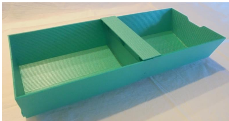
Figur 5.5.6: Aktermodul, sentermodul og toftemodul montert sammen. Aktermodulen er først skjøvet sidelengs inn i sentermodulens horisontale slissespor, deretter er toftemodulen satt ned over skjøten for å holde aktermodul og sentermodul sammen sidelengs, og i lengderetning.
