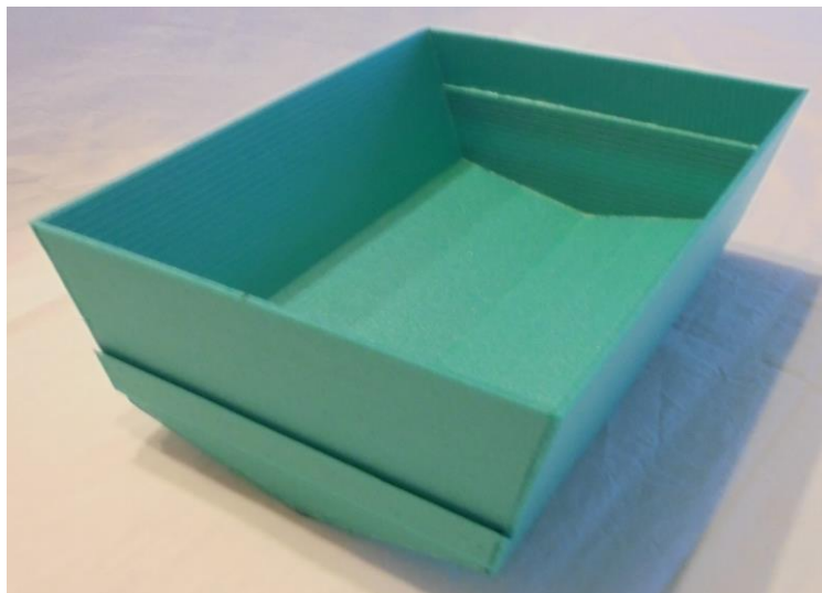
Figur 5.5.4: Prototype av sentermodul i målestokk 1:5 med horisontale slissespor bak og i front.
