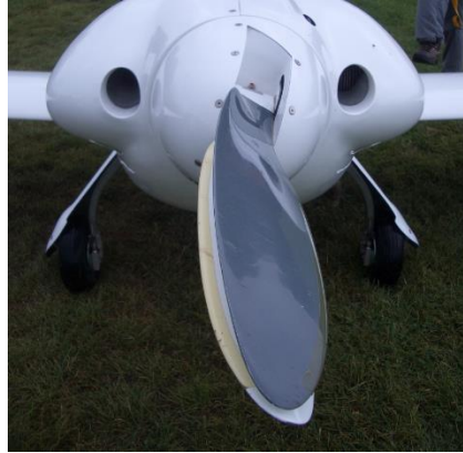
Figur 30: Sammenleggbar propell fra motorseilflyet Carat. Propellen sammenfoldedes utover. [54]
