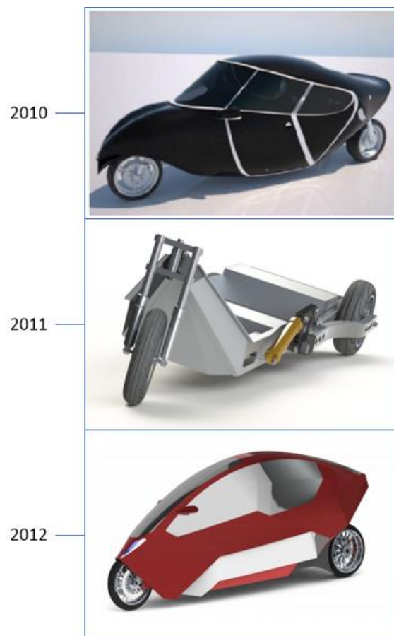
Figur 4: Oversiktsbilde av oppgavene knyttet til Dolphin Family. Fra toppen: Eksteriørdesign av Østby, Rammestruktur med bakhjulsoppheng av Aasheim, Eksteriørdesign av Leandersson. [7] [8] [9]
