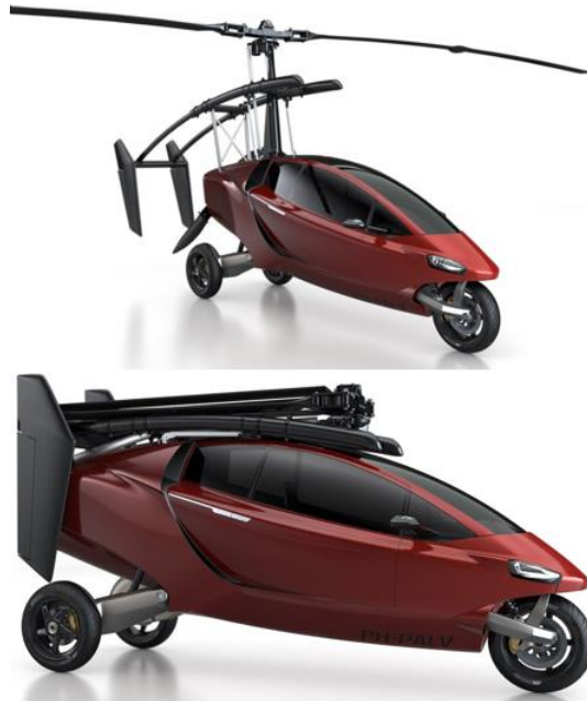
Figur 32: Sammenfolding av rotoren til flyvebilen Pal-V Liberty. [55]
