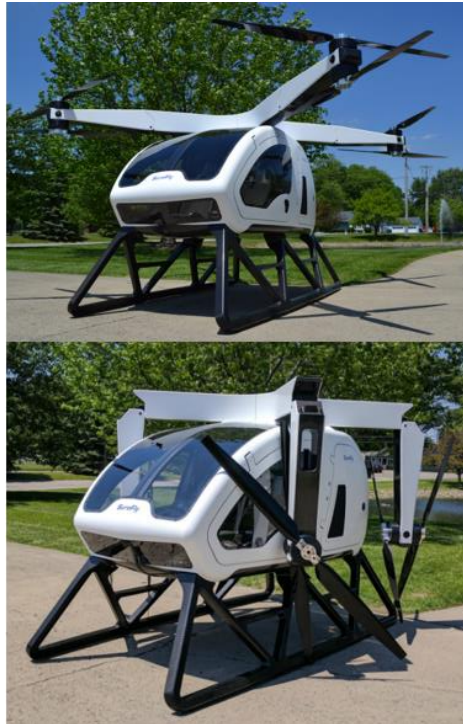
Figur 33: Persondronen Workhorse Surefly med propelloppheng som foldes ned på siden av kjøretøyet. [56]
