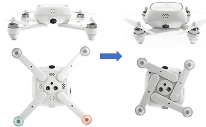
Figur 34: Bilde viser sammenfolding av propellarmene til RC-dronen Keyshare Kimon. [57]
