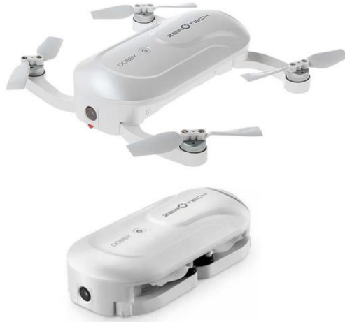
Figur 35: Bildet viser sammenfolding av propellarmene til RC-dronen Zerotech doobby. [58]
