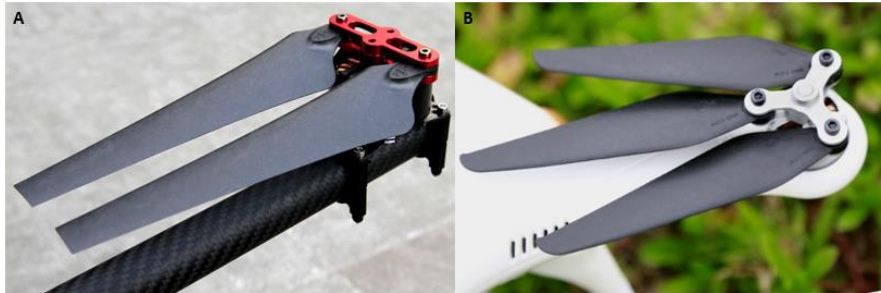
Figur 28: sammenleggbare propeller fra radiostyrte droner med to blader vist på bilde A og tre blader vist bilde B. [51] [52]
