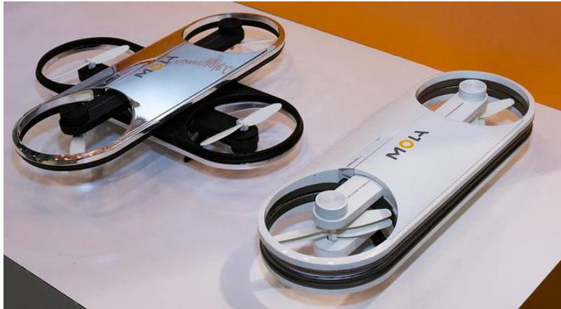
Figur 36: Bildet viser Nine Eagles mola X 1.0 sin unike sammenfoldingmetode. [59]
