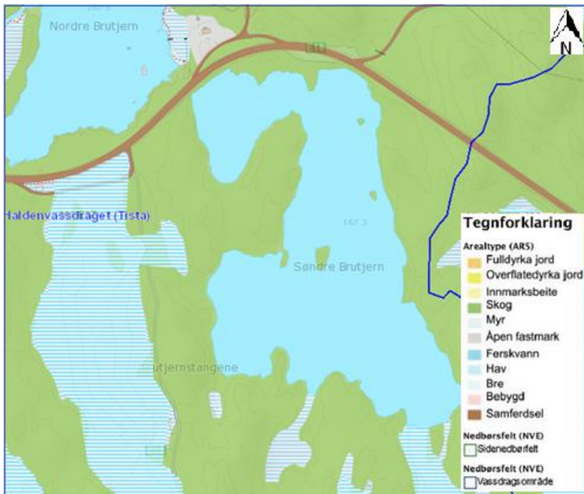
Figur 2: Kart over arealtyper (1:50 000) i nedbørsfeltet til Søndre Brutjern med skog over store deler av nedbørsfeltet og myrområder i vest og sørøst (blå stripper). Den brune strekken nord for innsjøen viser gamle E18 Riksgrensen – Ørje som nærmeste vei til innsjøen og som krysser mellom Nordre Brutjern og Søndre Brutjern (NIBIO 2017).
