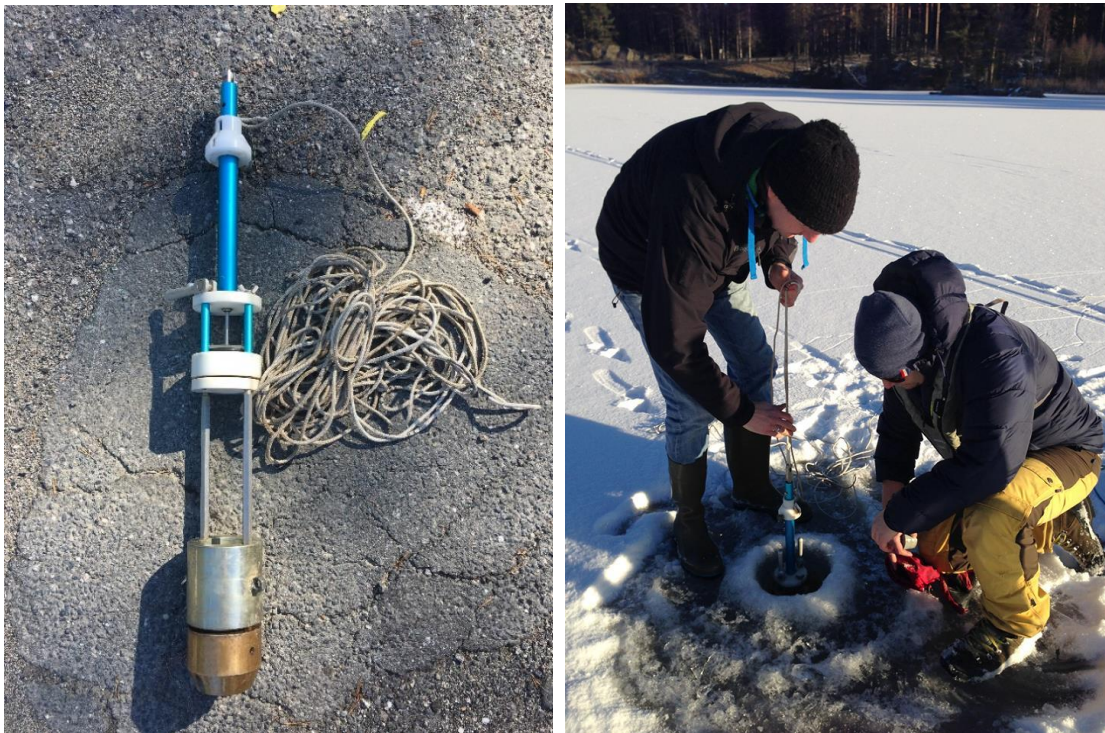
Figur 9: Bildet til venstre viser en sedimentprøvetaker (Uwitec sedimentprøvetaker) (Foto: Lööv 2017). Bildet til høyre viser Thomas Rohrlack (t.v. NMBU) og Ståle Haaland (t.h. NMBU) under prøvetaking av sedimenter i Søndre Brutjern med ved hjelp av en Uwitec sedimentprøvetaker (Foto: Rishatt 2017).
