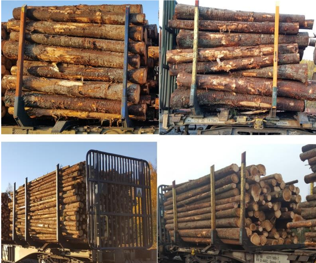
Figur 9. Bilde av vogner med høyt og lavt volum. Bilde øverst til venstre er av et lag med kubb med høyt volum. Bilde øverst til høyre er av et lag med kubb med lite volum. Dette laget har lav fastmasseprosent (uryddig) og har litt lav høyde. Bilde nede til venstre er av et lag med fallende lengder med høyt volum. Bilde nede til høyre er av et lag med fallende lengder med lavt volum. Dette laget har ujevn topp som medfører en lav høyde.
