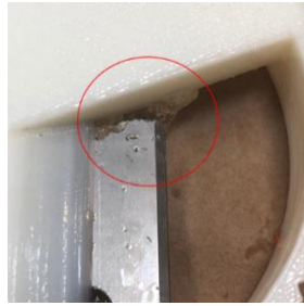
Figur 26: Nærbilde av knivbladet i skjæreløkket hvor glipen mellom knivbladet og kanten på åpningen i løkket (Foto: Kristian Olsen).
