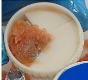
Figur 24: Laksebiter som satt fast i hulrommet i skjærelokket i test 3 (Foto: Idar Engebretsen).
