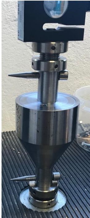
Figur 58: Testceller montert på maskin før det presses ned og etter laks har blitt presset ut av hullene i presselokket ( eget foto).
