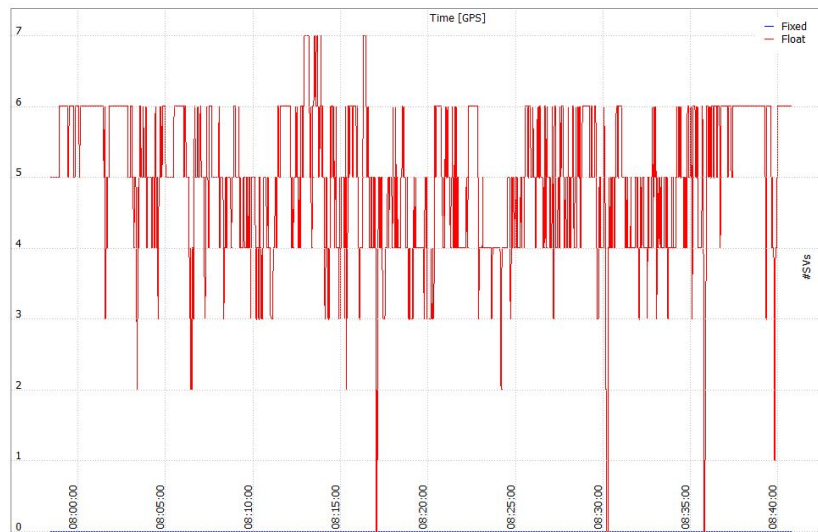
Figur 6.2.19: Fix & Float ved bruk av GLONASS og målesekk
