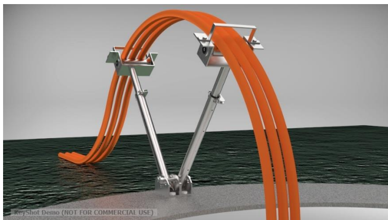
Figur 10.2: Illustrerer kabel plassering og produkt ved nedsenkning i sjø. Sett fra siden forfra.
