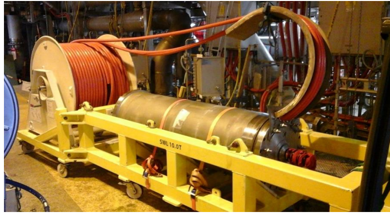
Figur 4.4: En spesialdesignet krybbe blir laget og tilpasset de ulike pumpemotorene for hver unike ordre. De transporteres i vannrett stilling. Kablene festes på motoren, i den ene enden, og kveiles på aluminiumstrommel, i den andre enden. For å ivareta maksimal bøyeradius er en «snabel» montert for å støtte kabelen ved transport. Foto: Eureka Pumps AS.
