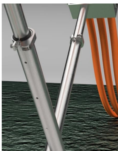
Figur 10.5: Nærbilde av muligheten til å justere armlengdene.
