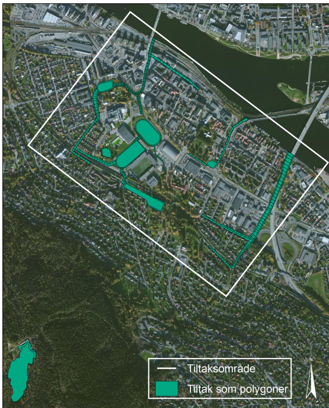
Figur 3-9: Tiltak tegnet som 450 polygoner i ArcGIS Desktop. Hver polygon ble tillagt egen høyde manuelt. Illustrasjon laget av Grimmes.
