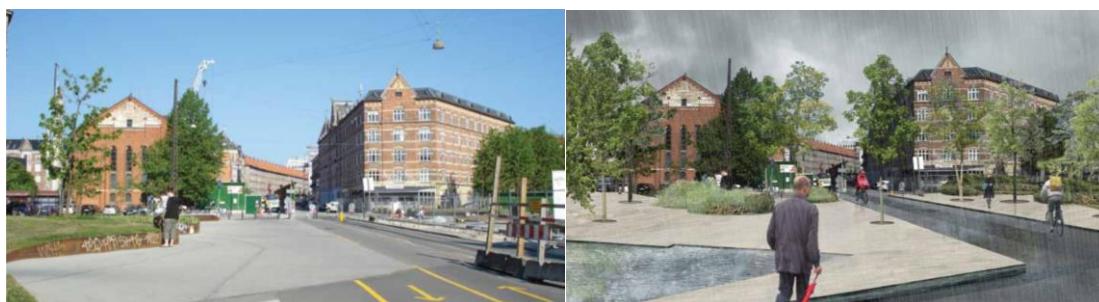
Figur 2-10: Fordrøyningsdam i sentrum. Eksempel på sentral forsinkelse som oppgraderer eksisterende byrom. Hentet fra skybrudsplanen til Københavns kommune (2012).
