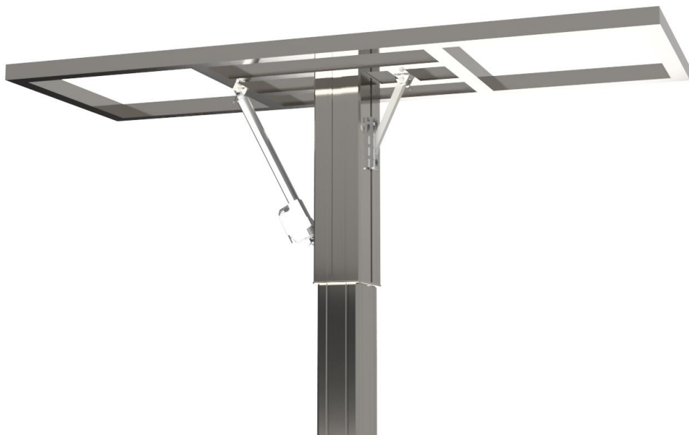
Figur 155: Renderte framstillingen av festemekanismen fra løftemekanismen til sengerammen
