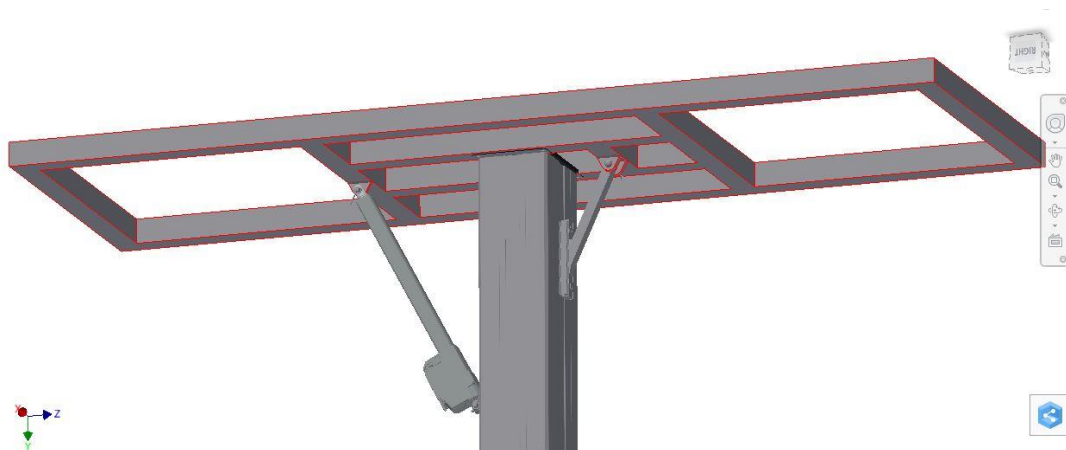
Figur 134: Viser til festepunktet mellom løftekolonnen og sengerammen
