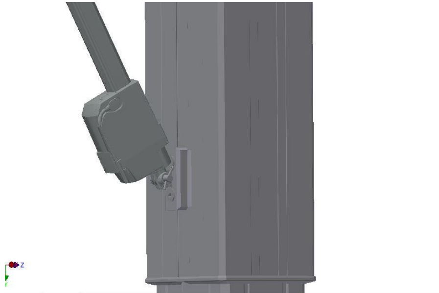
Figur 136: Viser festpunkt mellom lineære aktuatoren og løftekolonnen
