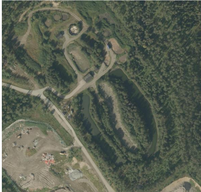
FIGUR 1.21 BARDU RENSEANLEGG I TROMS MED SLAMBASSENG I NORD OG INFILTRASjonsBASSENG I SØR (FLYFOTO, KARTVERKET).
