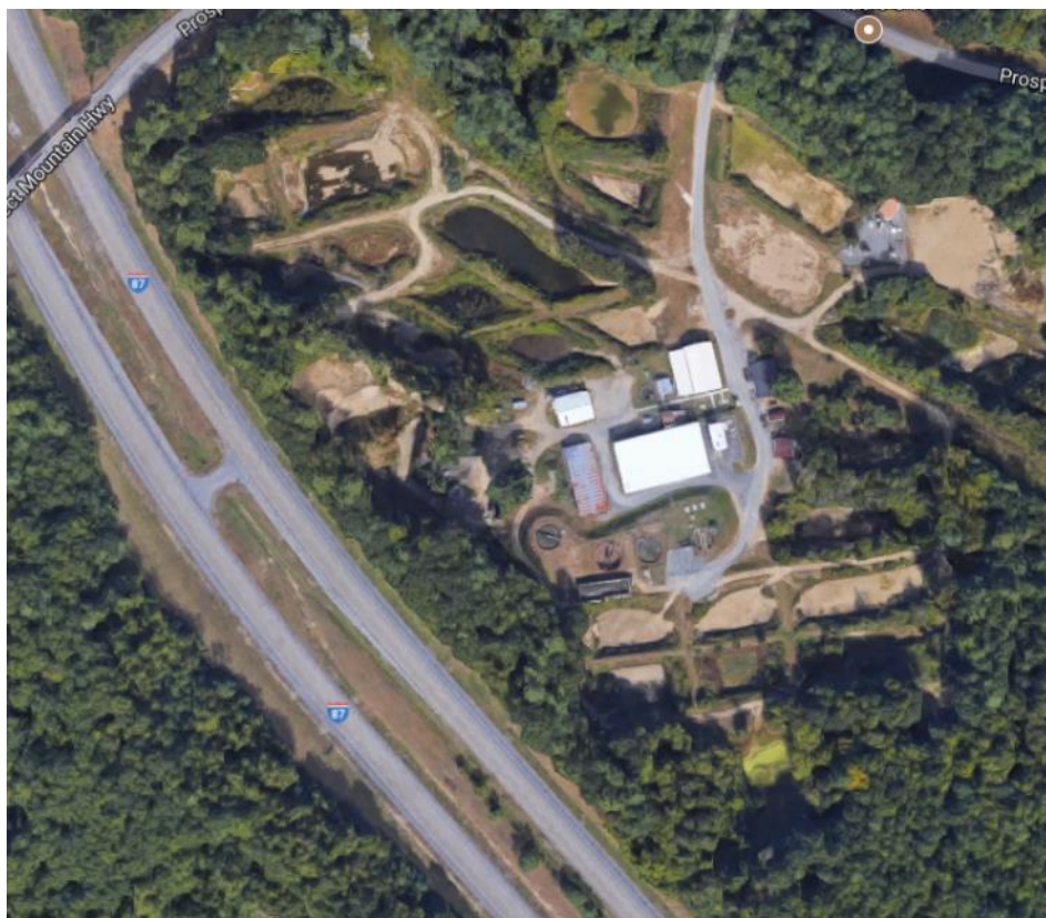
FIGUR 1.24 FLYFOTO AV AVLØPSBEHANDLING VED LAKE GEORGE, NEW YORK, USA. FORBEHANDLING I ÅPNE SEDIMENTERINGSBASSENG (U.S. EPA, 2006) SØR FOR ANLEGGSBYGG. BASSENGENE ER I ULIKE STADIER AV UTTØRNING (FLYFOTO, GOOGLE EARTH).
