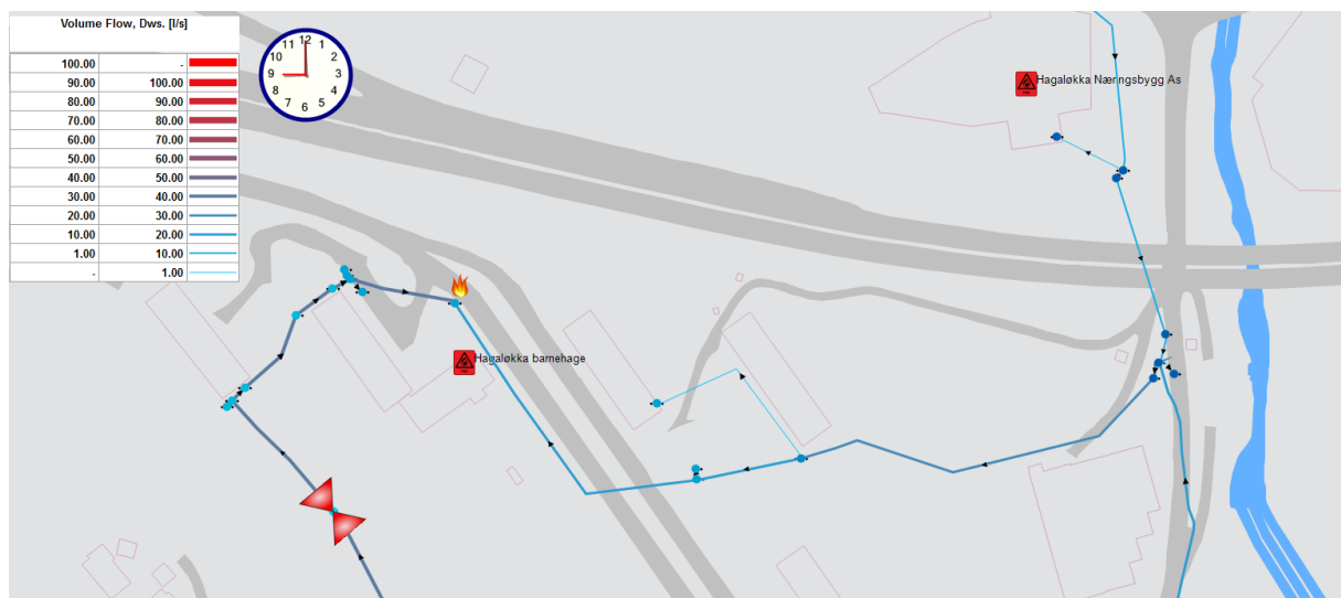
Figur 9. Resultat av tiltak 3. Utklipp fra simulering i Aquis. Viser strømningsforhold.
