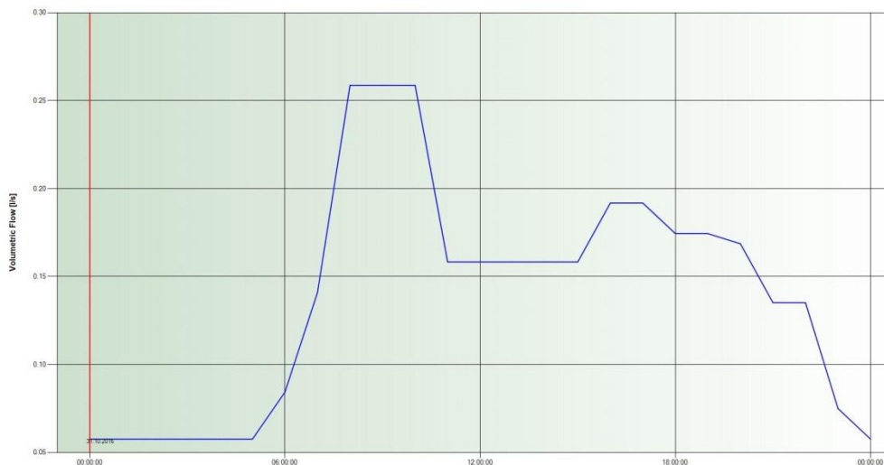
Figur 3. Forbruksvariasjon over et døgn for eneboligområdet (Aquis modell 20170912 2017). Tid i timer på x – akse og volumstrøm i l/s på y – akse.
