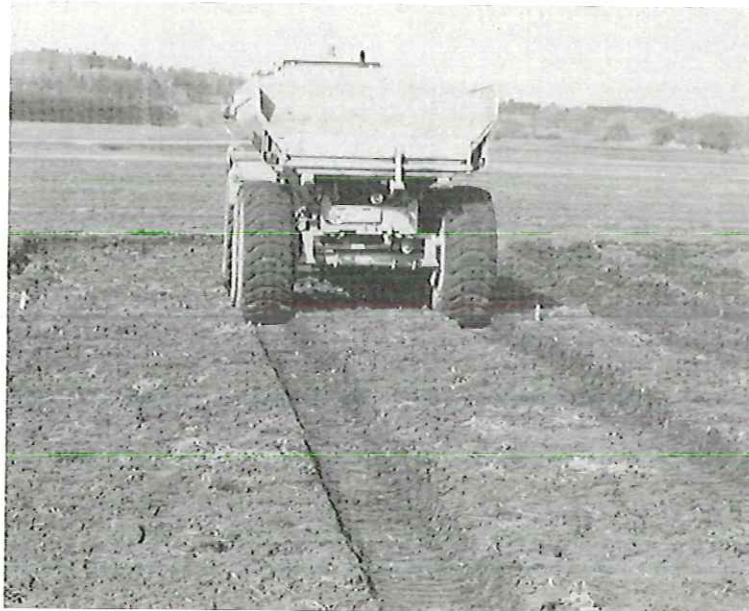
Figur 3. Kjøring med dumper på utlagte løsmasser gir dype hjulspor og pakningsvirkning dypt nedover i jorda. Slik kjøring må unngås på Fornebu.
