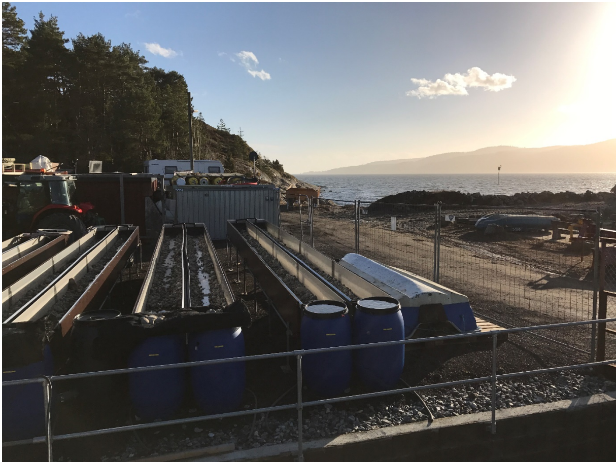
Figur 17. Forsøksrenner med bekkeløp på NIVA sitt testanlegg på Solbergstrand i Frogn. Foto: Aina Charlotte Wennberg/NIVA
