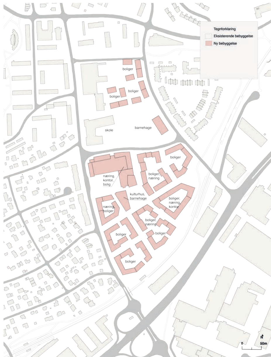
Figur 89: Bygningsstruktur og funksjoner i bygningene
