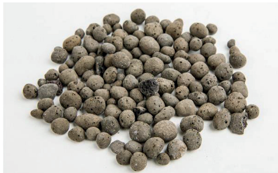
Figur22: Leca-kuler er blir ofte brukt i jordblandinger på tak for å gjøre taket lettere. Bruk av leca og andre lette materialer kan ha uheldige konsekvenser ved at vekstsubstratet tørker ut lettere.
