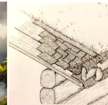
Bilde 3.4 - Prinsippskisse torvtak. Tegning: Eugen Ulmer (2008)
