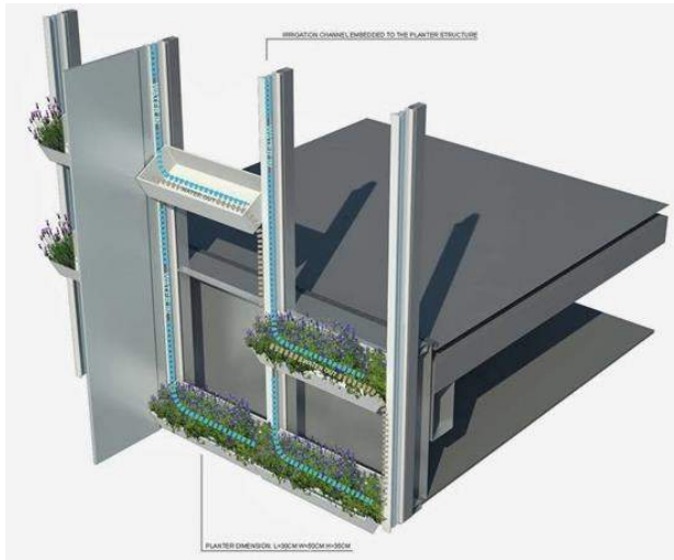
Figur 3.4 - Planteboksene får vanntilførsel fra irrigasjonsledninger festet på bæresystemet. Figur: Aedas arkitektkontor
