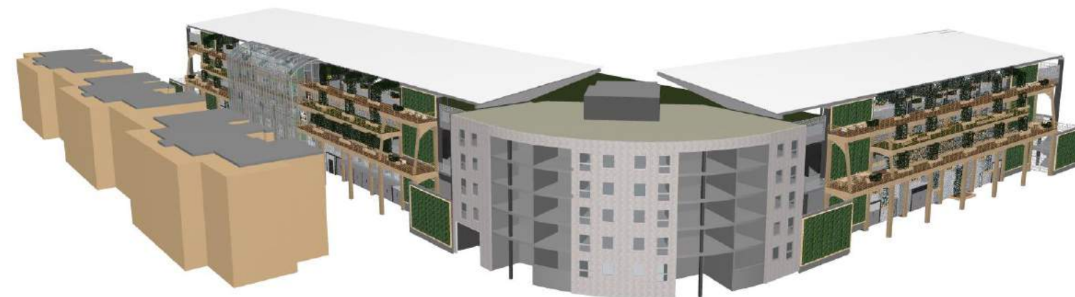
Bilde 7.4 - Alle alternativer (alternativ 4) på Skagerak arena; plantebokser, modulvegger, svalganger og plantetårn i drivhus. Figur: Knut Feilberg
