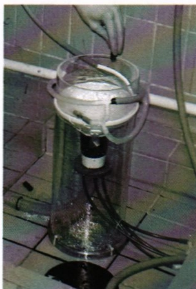
Figur 4-8: Prototyp av singuleringssystem
