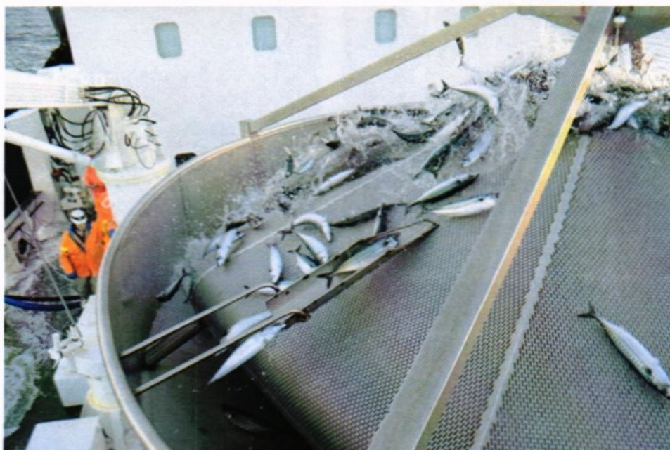
Figur 4-5: Bilde av rennesystem i avsilingssone i silkasse ombord på M/S Kings Bay
