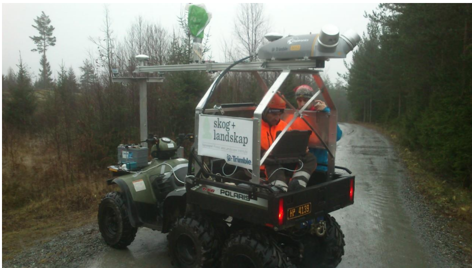
Figur 4: Trimble MX2 montert på en ATV. Foto: Jan Bjerketvedt
