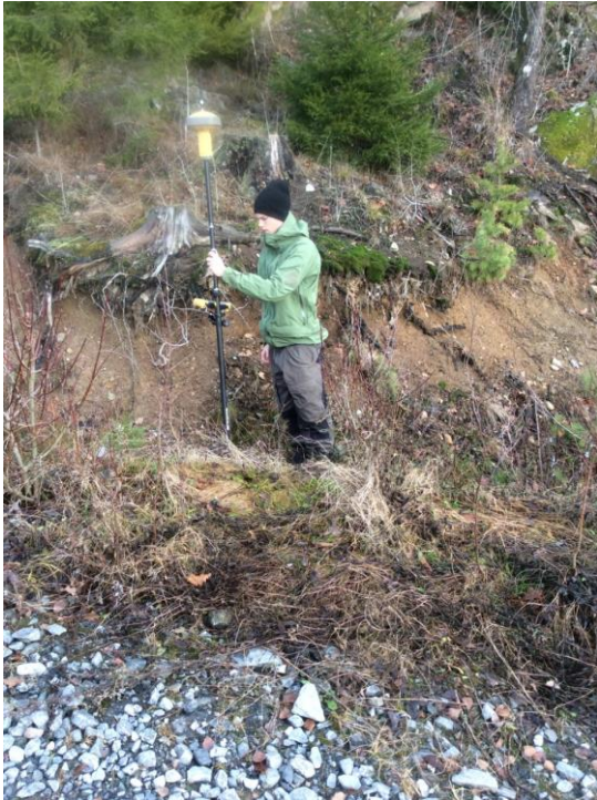
Figur 6: Referansemåling med landmålingsutstyr. Foto: Jan Bjerketvedt
