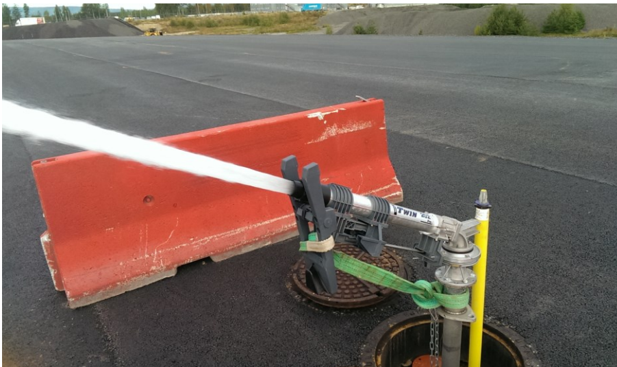
Bilde 1 Vannkanon som brukes til å spre overskuddsvann fra snøkjøleanlegget til omliggende terreng
