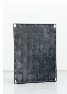
Figur 43: Biter av gulvbelegg som fasadekledning 31
