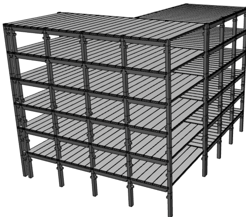
Figur 103: 3-D tegning av skisseprosjektets bæresystem
