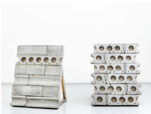
Figur 41: Oppskårede betongelementer som veggkledning
