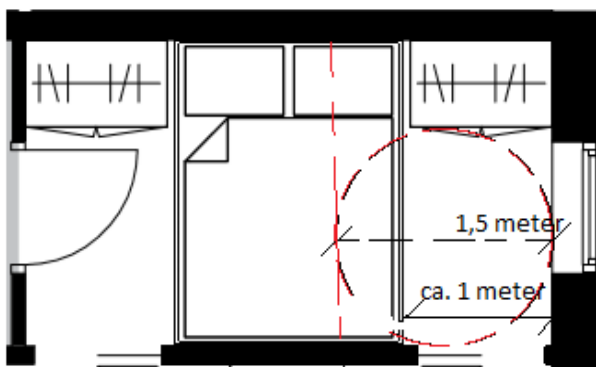
Figur 7- Bildet er hentet fra boligprosjektet 1912 i Bergen og viser et eksempel på en bolig som kunne vært utformet tilgjengelig, men som i denne undersøkelsen registreres som 'tilgjengelig bolig med forbehold'. Som man kan se av plantegningen ville en mindre sengedimensjon gitt plass til en snusirkeldiameter på 1,5 meter slik at kravet til tilgjengelighet på soverommet hadde blitt oppfylt.
