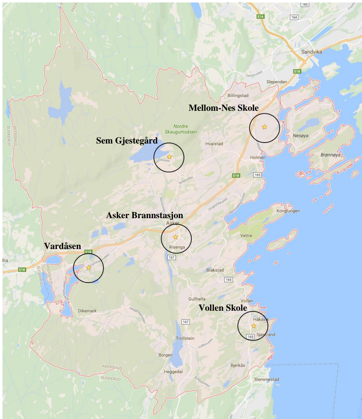
Figur 7: Plassering av nedbørmålere i Asker Kommune
