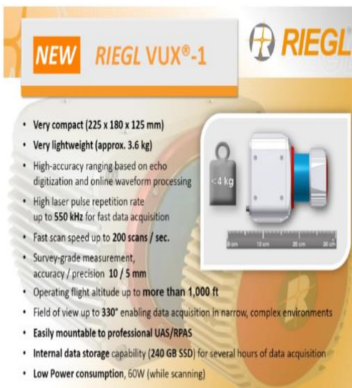
Figur 10: Produktdetaljer Riegl VUX-1 (Riegl Corporation, 2015)
