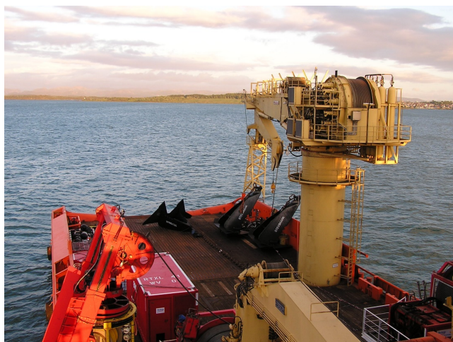
Figur 15-2 Hywind Demo 2009 - Plassering av drag-ankere (Nedrevaag 2011a).
