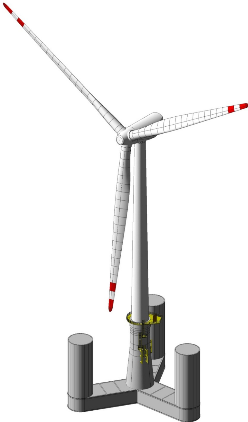
Figur 2-1 OOStar Wind Floater designet av Dr.techn Olav Olsen (Dr.techn. Olav Olsen u.d.).
