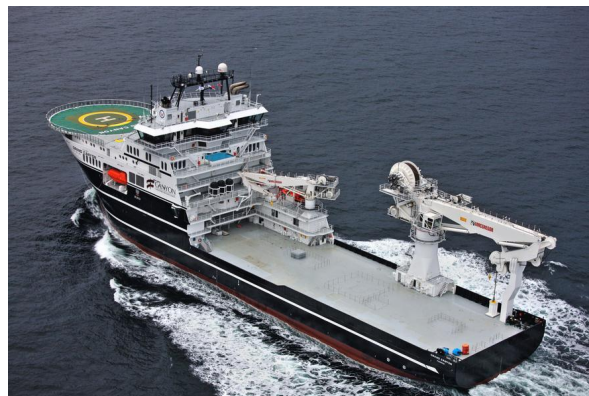
Figur 15-18 AHC kraner montert på et offshore fartøy.
