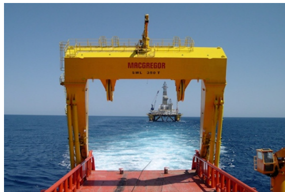
Figur 15-17 A-frame montert lengst bak på en AHTS.
