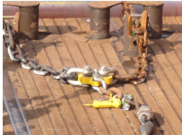
Figur 15-16 Triplate og ROV-sjakkell til Hywind Demo i 2009. (Nedrevaag 2011b)
