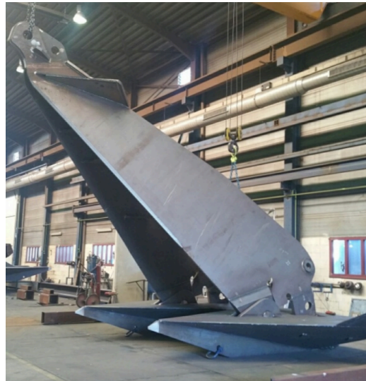
Figur 15-8 Drag -anker til forankring av Floatgen (Floatgen 2017b).
