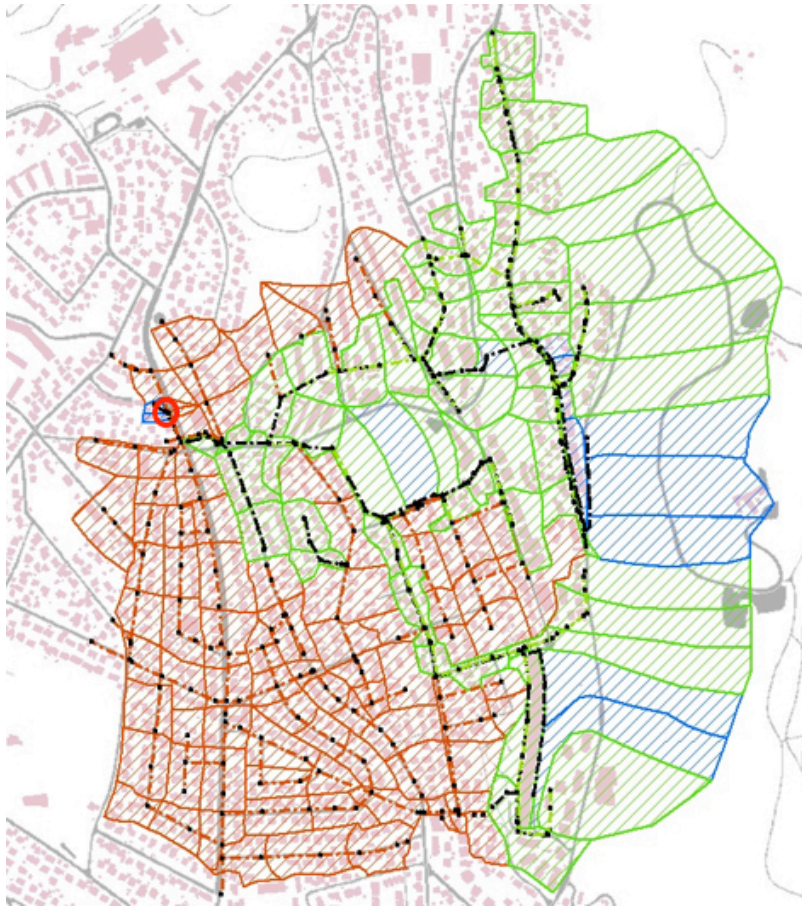
Figur 1.19 Oversiktskart over feltområdet. Delfelt i rødt viser fellessystemet. De grønne og blå delfeltene viser separertsystem (grønn spillvann og blå overvann).
