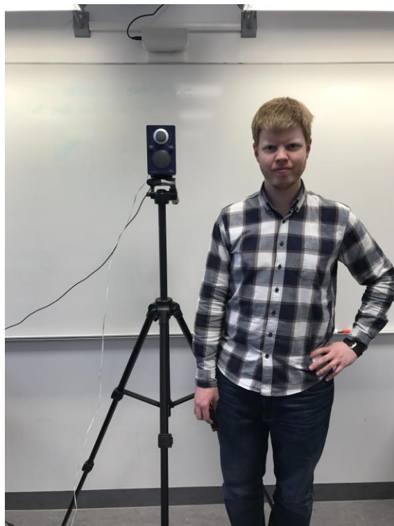
Bilde 4: Sender med fiksert målehøyde på 1.7 m over gulvet.
