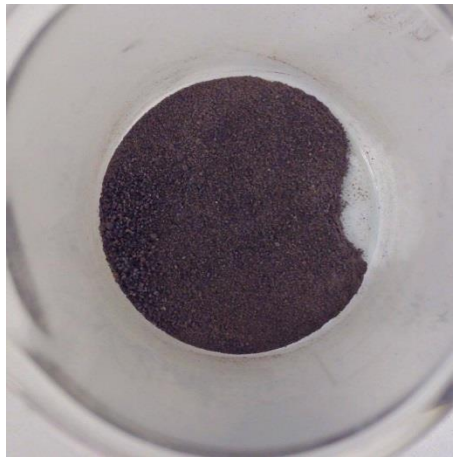
Figur 4 Bildet viser det knuste filtermaterialet, før tilsetning av HNO 3 og HCl.
