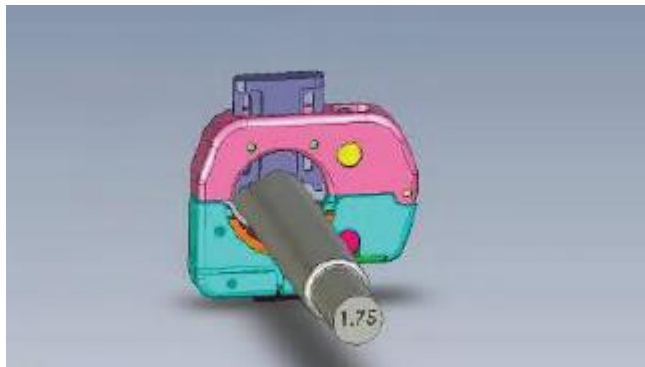
Figur 3.16: Den rosa og den blå biten illustrerer selve sensoren montert på kompresjonskonnektoren. Figuren er hentet fra [2].
