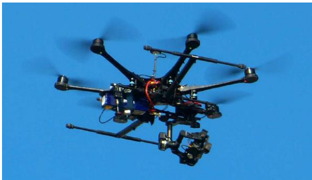
Figur 1.1: Ved å feste UV-kameraet på en drone åpner muligheten for tilstandskontroll. Bildet er hentet fra [4].
