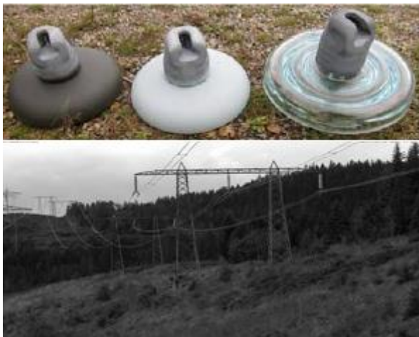
Figur 3.19: Her har man foretatt synlighetstesten på tre ulike glassisolatorer med forskjellige fargetrekk; grønn-oliven, grå og standard. Bildet er hentet fra [37].
