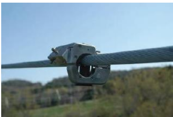
Figur 3.17: Her ser vi hvordan sensoren er omsluttet lederen for å foreta målinger. Figuren er hentet fra [2].
