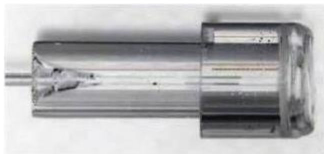
Figur 3.11: Slik ser en AFO-sensor ut. Bildet er hentet fra [2]
