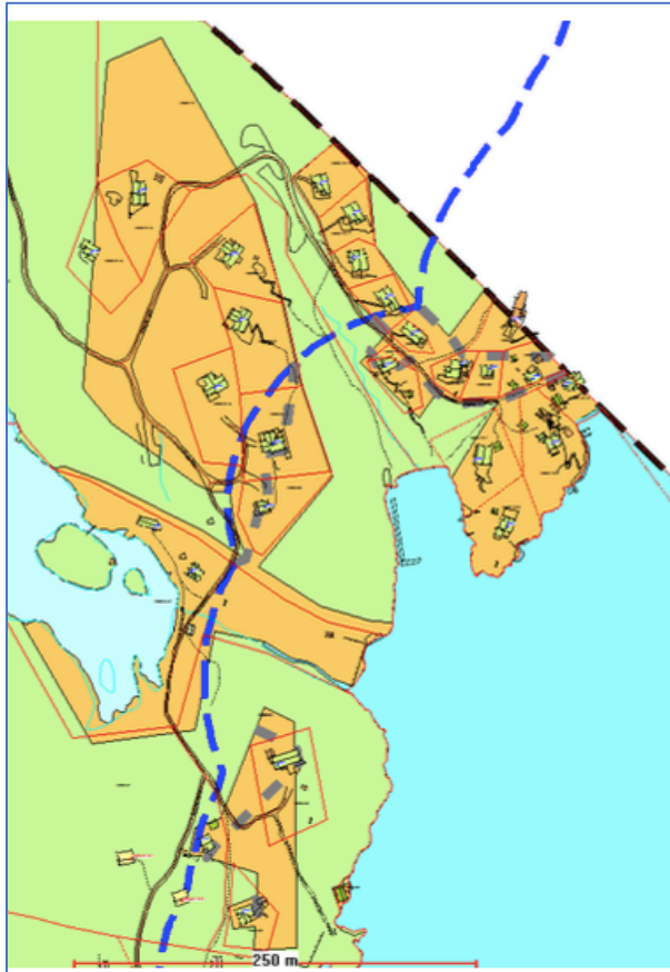
Figur 5: Kartutsnittet viser hvordan byggegrenser er trukket i områder som i reguleringsplan er regulert til fritidsbebyggelse (oransje områder). Blå stiplet linje er 100-meterslinjen, og grå stiplet strek viser byggegrenser mot sjø. Byggegrensene er dessverre vanskelig å se i kommunens kartutsnitt. Kilde: (Larvik kommune 2016c).
