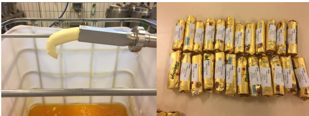
Figur 16: Hvilerør og manuell pakking til ferdig emballert produkt ved fremstilling i pilotskala (Foto: Aurora Olsen).
