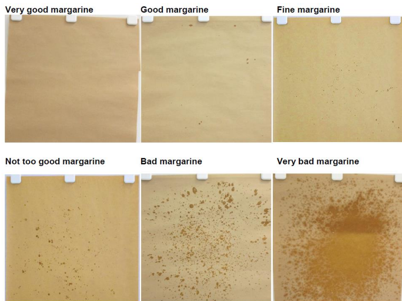
Figur 19: Eksempler på bedømmelse benyttet til karaktersetting av margarinenes stekeegenskaper fra 1 til 9 (Foto: DuPont).
