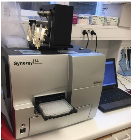
Figur 25: Mikroplateleser benyttet til å måle prøvenes absorbans ved 532 nm.
