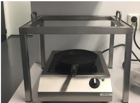
Figur 18: Oppsett for steketest med stekeplate, stekepanne og stativ hvor gråpapiret festes over stekepannen (Foto: Aurora Olsen).
