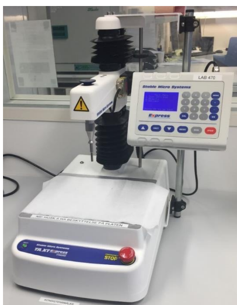
Figur 17: Teksturanalyse ble utført med TA.XT Express fra Stable Micro Systems (Foto: Aurora Olsen)
