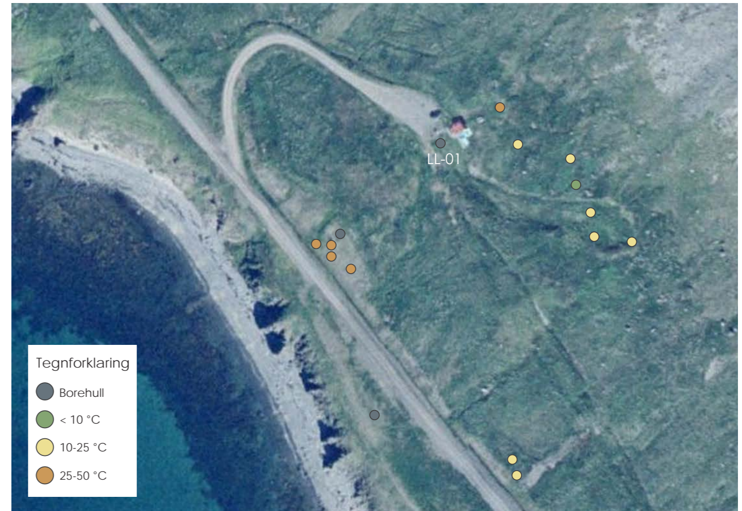
Figur 70: Funn av geotermisk varme på overflaten, og borehullenes plassering
