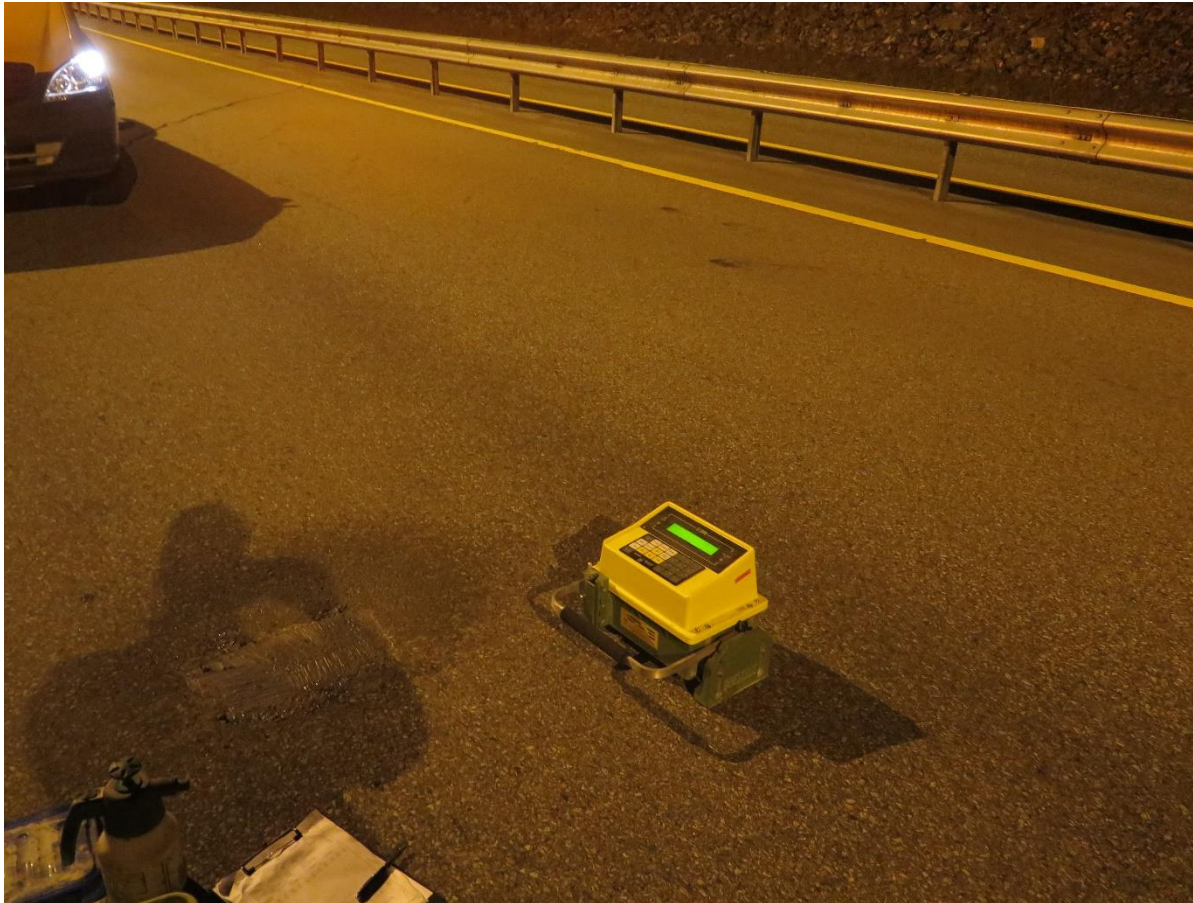
Figur 2.2.4: Et bilde av en Seaman C-300 isotopmåler (Foto: Viktor Hedfors)
