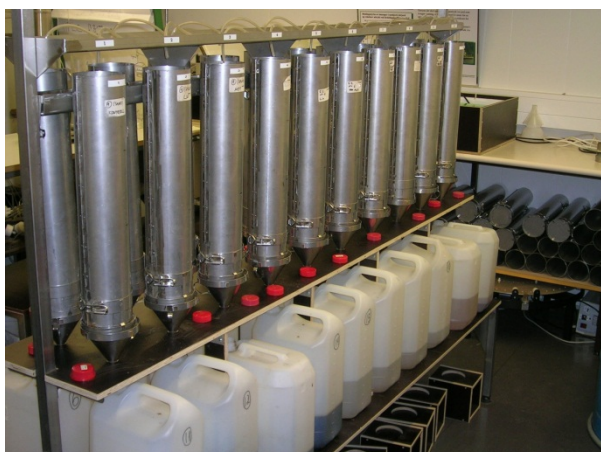
Figur 1. Søyleoppsett for å studere utlekking av plantevernmidler gjennom ulike filtermaterialer.
