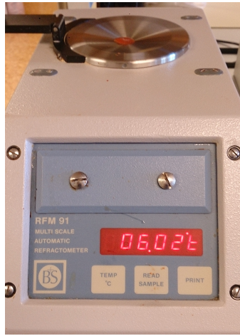
Figur 16: Måling av °Brix i tomatpuré ved hjelp av ett Bellingham/Stanley refraktometer (RFM-91, Bellingham-Stanley, Kent, England).
