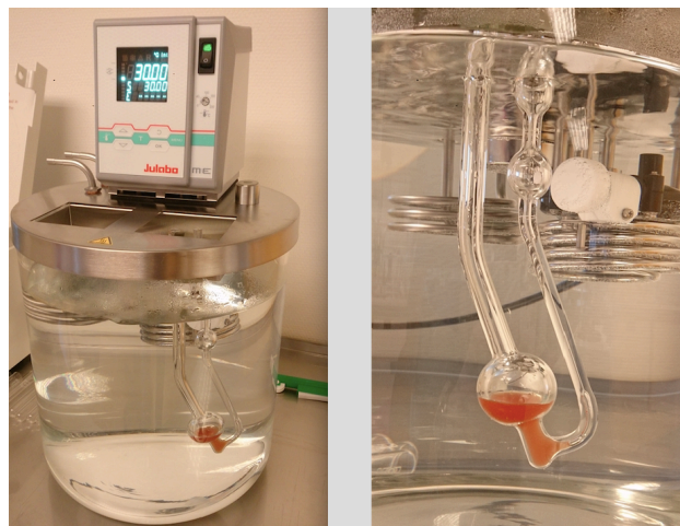
Figur 17: ME-16G Visco Bath (Julabo GmbH, Seelbach, Tyskland) med kappilærviskometeret til venstre og Cannon-Fenske Routine Viscometer 971 (Cannon Instrument, PA, USA) til høyre.
