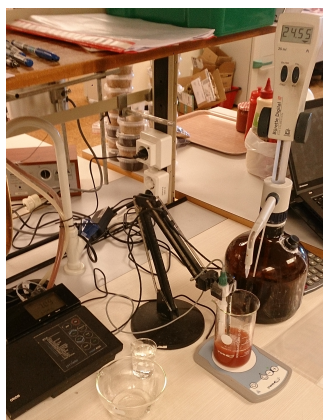
Figur 18: Titrering av tomatpuréløsning med 0,1 M NaOH for beregning av totalt syreinnhold.
