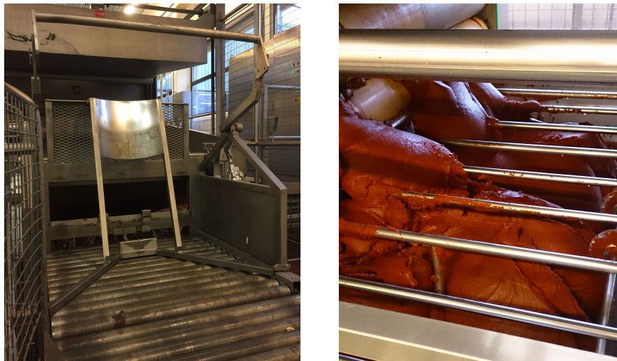
Figur 14: Produksjonsanlegget til Idun, der transportbåndet for kasser med tomatpuré inn til fattømmer er illustrert til venstre og fattømmer med tomatpuré vises til høyre.
