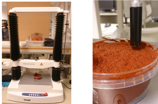
Figur 19: Til venstre; Teksturanalysator (TA.HD Plus, Stable Micro Systems, Surrey, England) og til høyre tilhørende probe på vei ned i PP-beger med tomatpuré.
