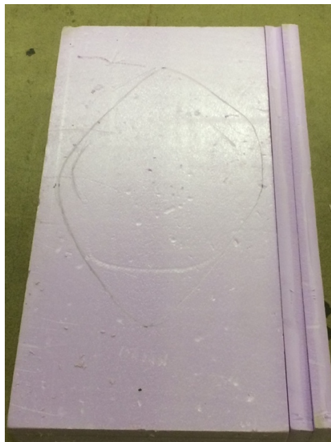
Figur 104: Testplattformen med ekstra plater pålimt fra siden.
