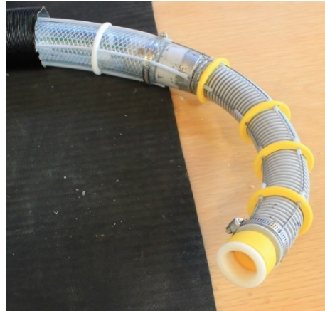
Figur 75: Prototypens defleksjonsmekanisme med ca 90 graders bøy.
