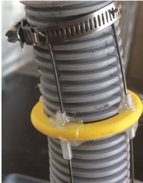
Figur 145: De to ståltrådene som er avbildet blir fjernet.
