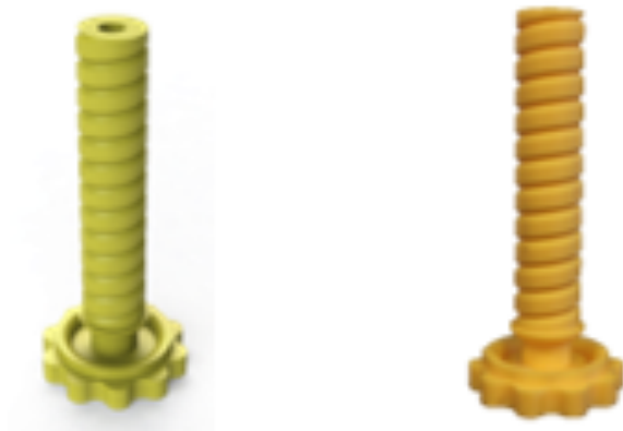
Figur 43: Til venstre illustreres 3D-modellen av forlengelseskruen. Til høyre illustreres printet resultat av forlengelseskruen.
