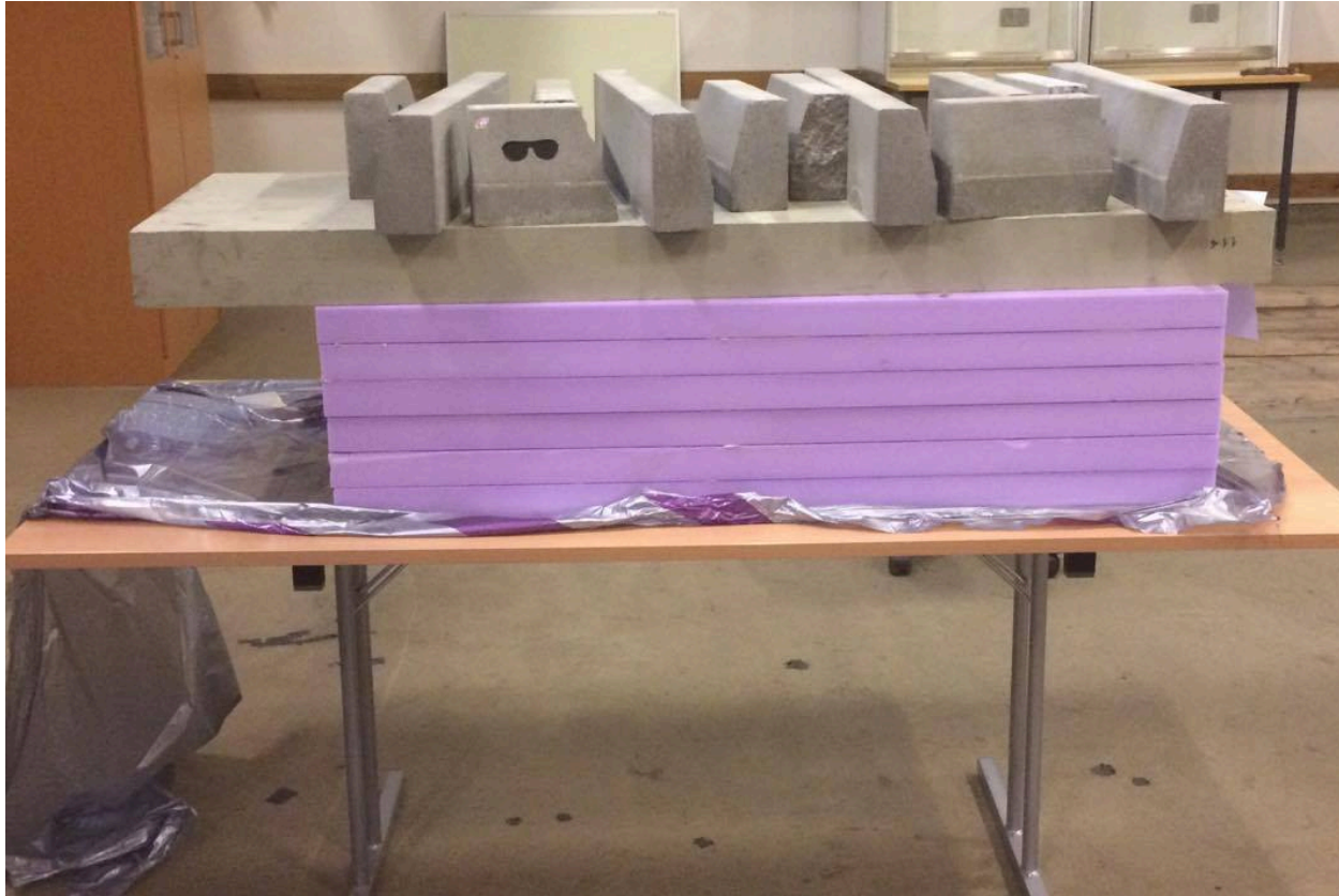
Figur 101: Platene limt sammen med påsatt vekt.
