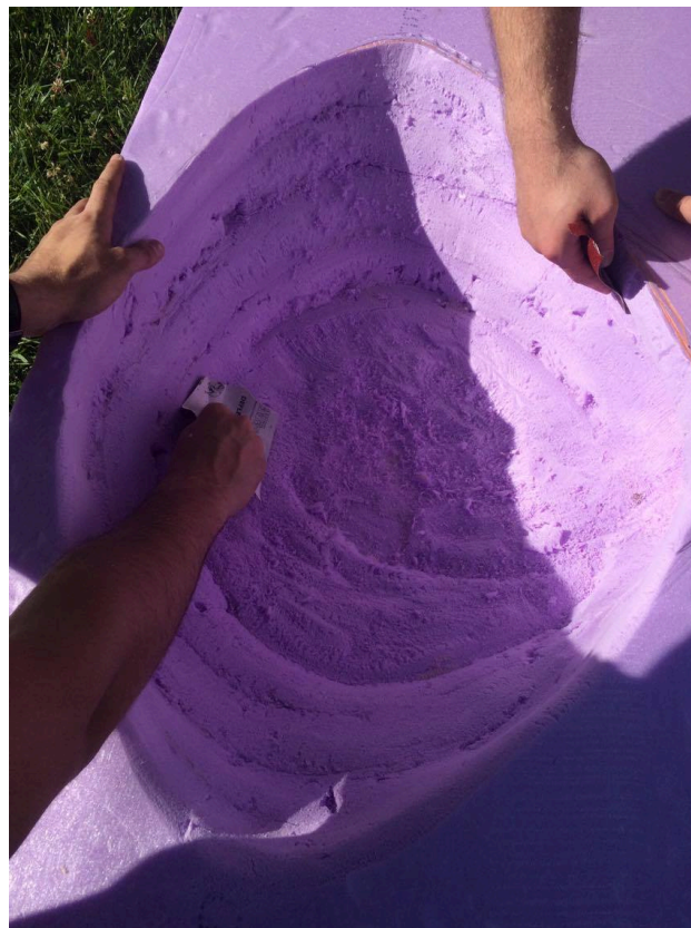
Figur 110: Innsiden av modellen blir pusset med sandpapir.
