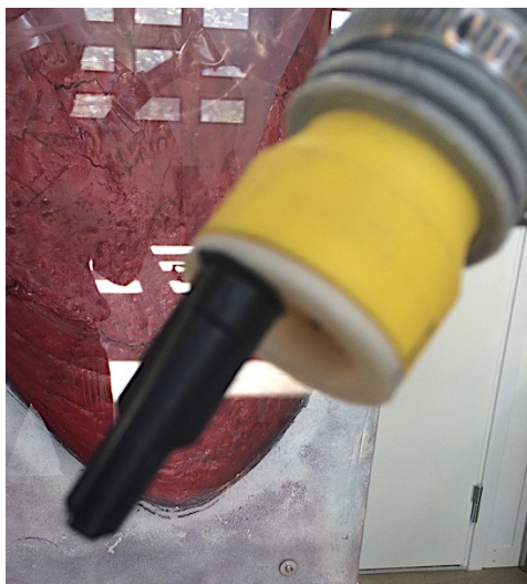
Figur 147: Distalende med pålimt tusj-kork.
