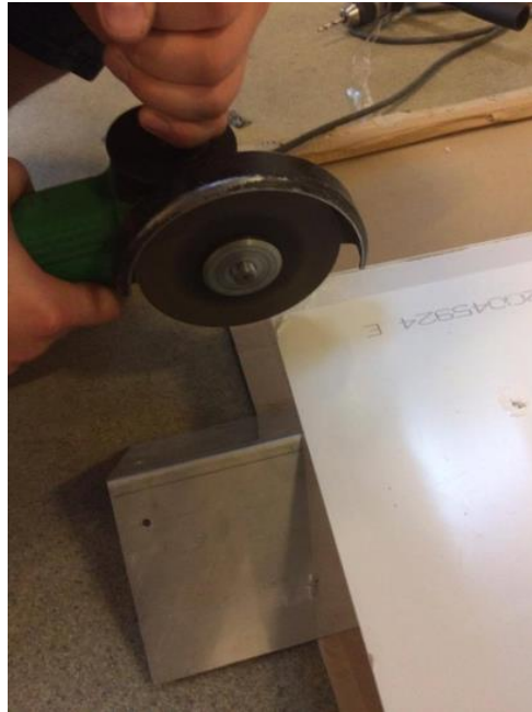
Figur 130: Pleksiglass blir kuttet til riktig størrelse.
