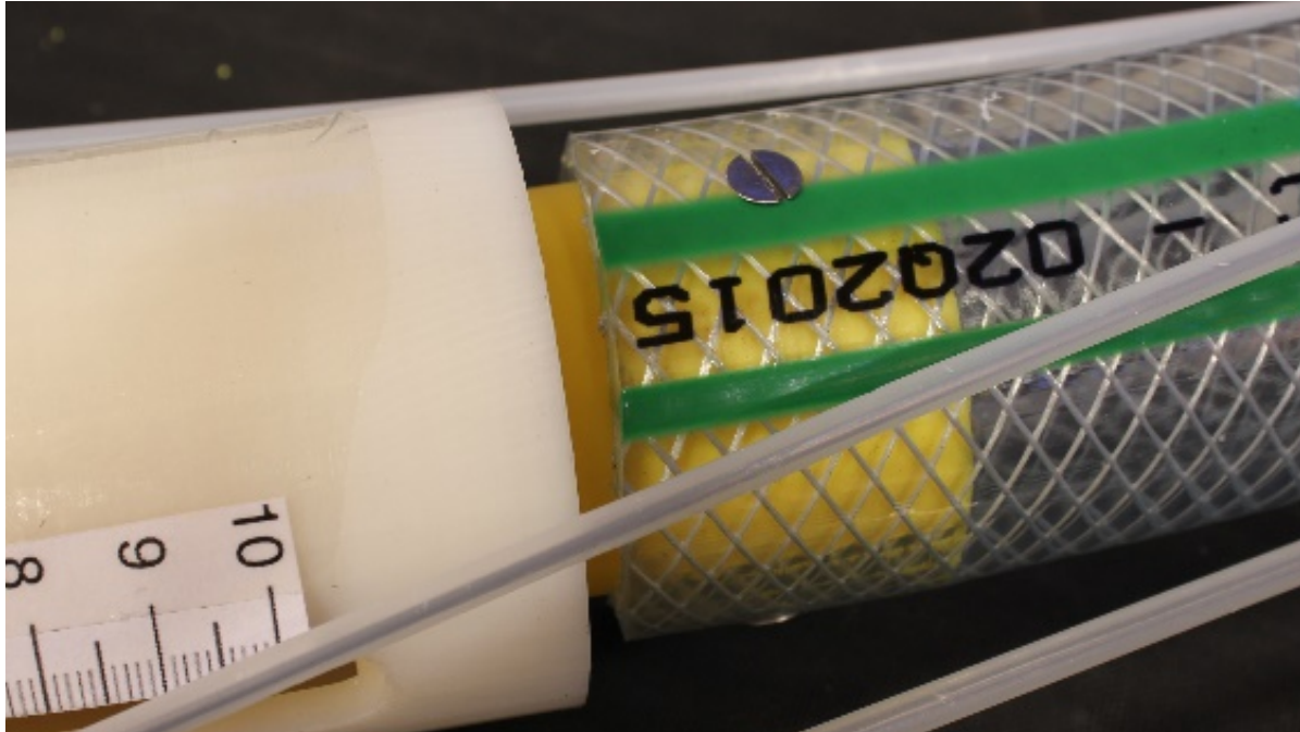
Figur 73: Festepunkt mellom forlengelsesmekanismen og den indre slangen.
