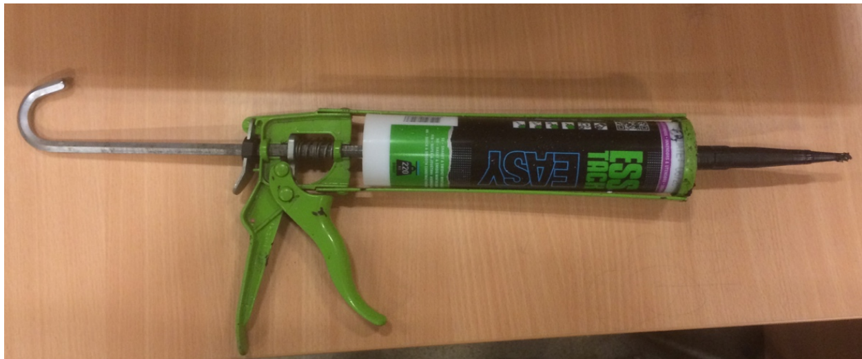
Figur 126: Monteringslimet som ble brukt "ESS track easy"
