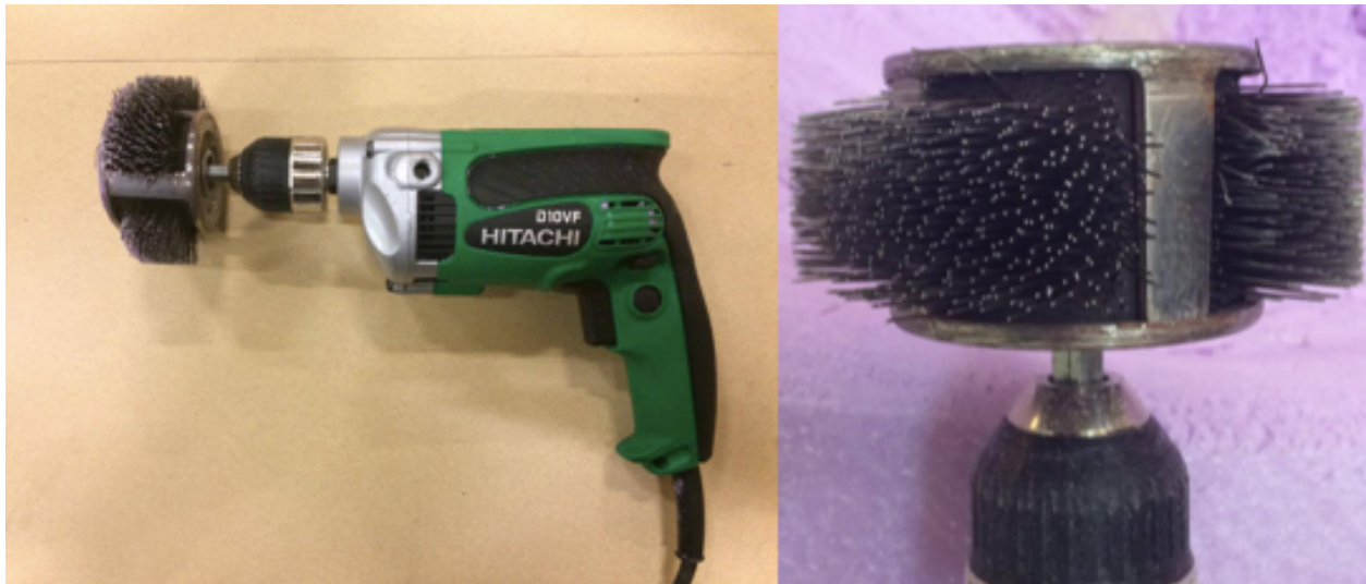
Figur 107: Drill med påsatt stålbørste.
