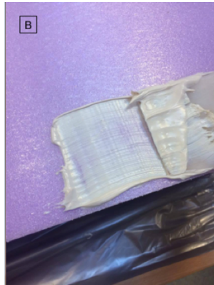
Figur 99: A) Kontaktlimet som ble brukt, "Bostik kontaktlim". B) Kontaktlim påføres ved hjelp av en sparkelspade.
