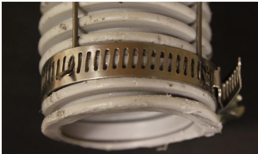
Figur 67: Festepunkt av alle defleksjonstråder på støvsugerslangen.
