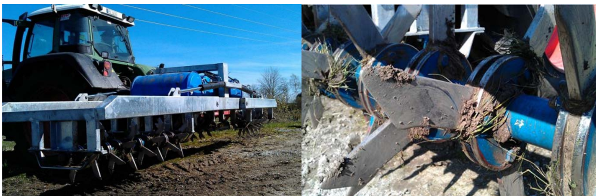
Figur 3.5: (t.v.) Glenside oxygenerator er tre meter bred og har fire balasttønder oppå redskapen for å sikre at godt arbeid blir utført. (T.h.) På akslingen er det montert rektangulære stålskiver som danner åpninger i jordoverflata.
