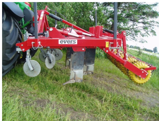
Figur 3.4: Evers sward lifter er tre meter bred og har fem løsneorganer med pakkere/tromler bakerst.
