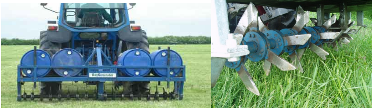
Figur 2.10 t.v.: En aerator er hovedsakelig konstruert for å øke luftgjennomstrømning i jordoverflata av enga og å forbedre infiltrasjonsevnen av vann (Bhogal et al. 2011).
