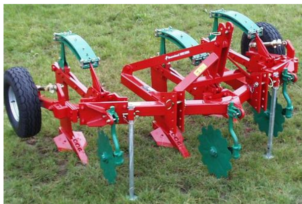
Figur 2.13: Kverneland CLE grubb med tre tinder og vingskjær (Kverneland, 2016).
