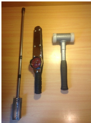
Figur 3.8: Utstyr som brukes ved skjærfasthets målinger. Vingebor t.v., momentnøkkel midten og hammer t.h.
