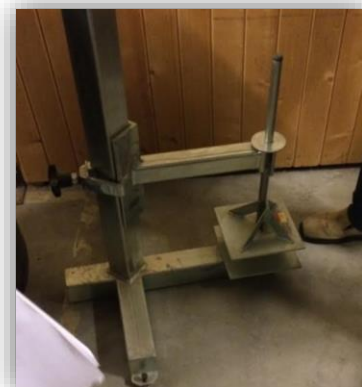
Figur 3-2: Forsøksapparat for trykktesting
