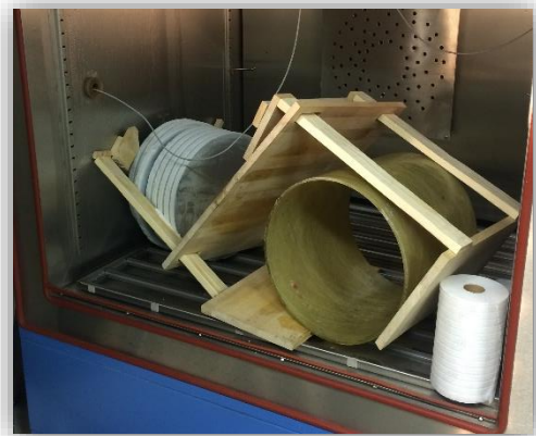
Figur 7-1: Ulykke ved avlasting forsøk 1, rør 2 grunnet frost og kondens
