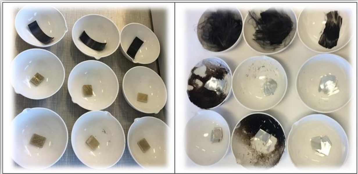
Figur 4-2: Materialprøver før og etter brenntest
