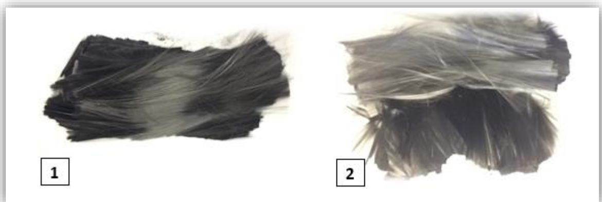
Figur 4-3: Fiberstruktur for testrør 1. Lag 1 og lag 2
