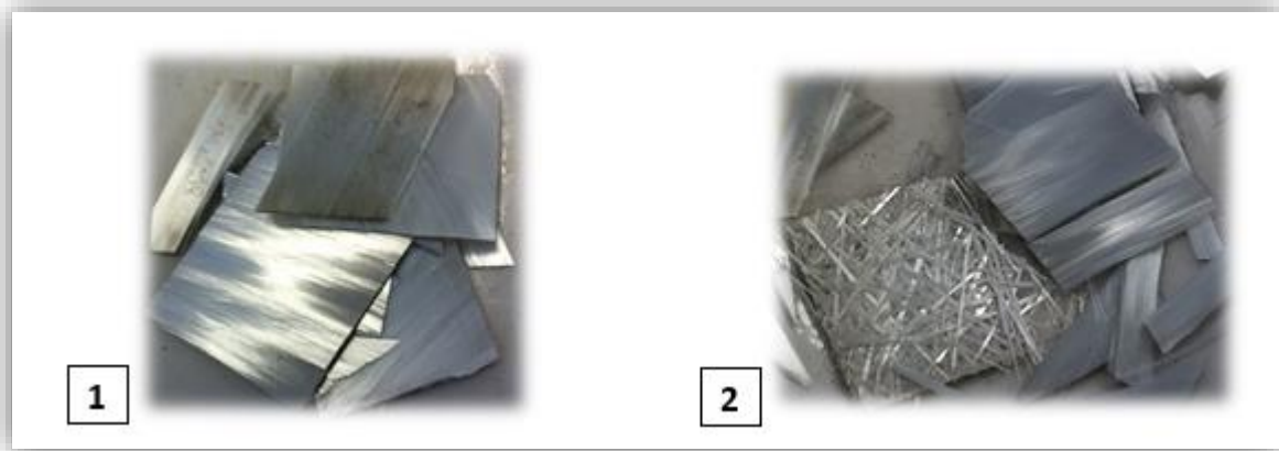
Figur 4-4: Fiberstruktur for testrør 2, Lagdeling 1: kryssviklet kontinuerlig fiber, Lagdeling 2: korte fiber m tilfeldig fiberretning
