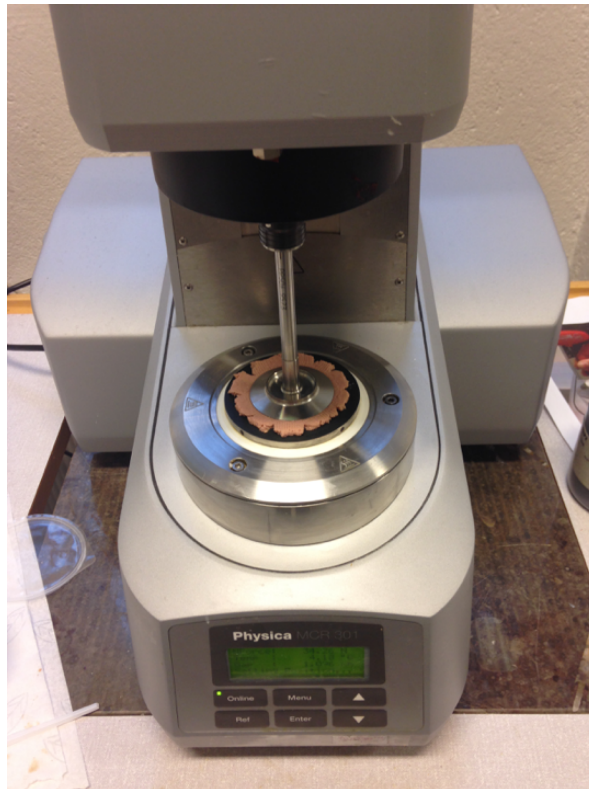
Figur 14: Reologiske analyser av leverpostei-prøver.
