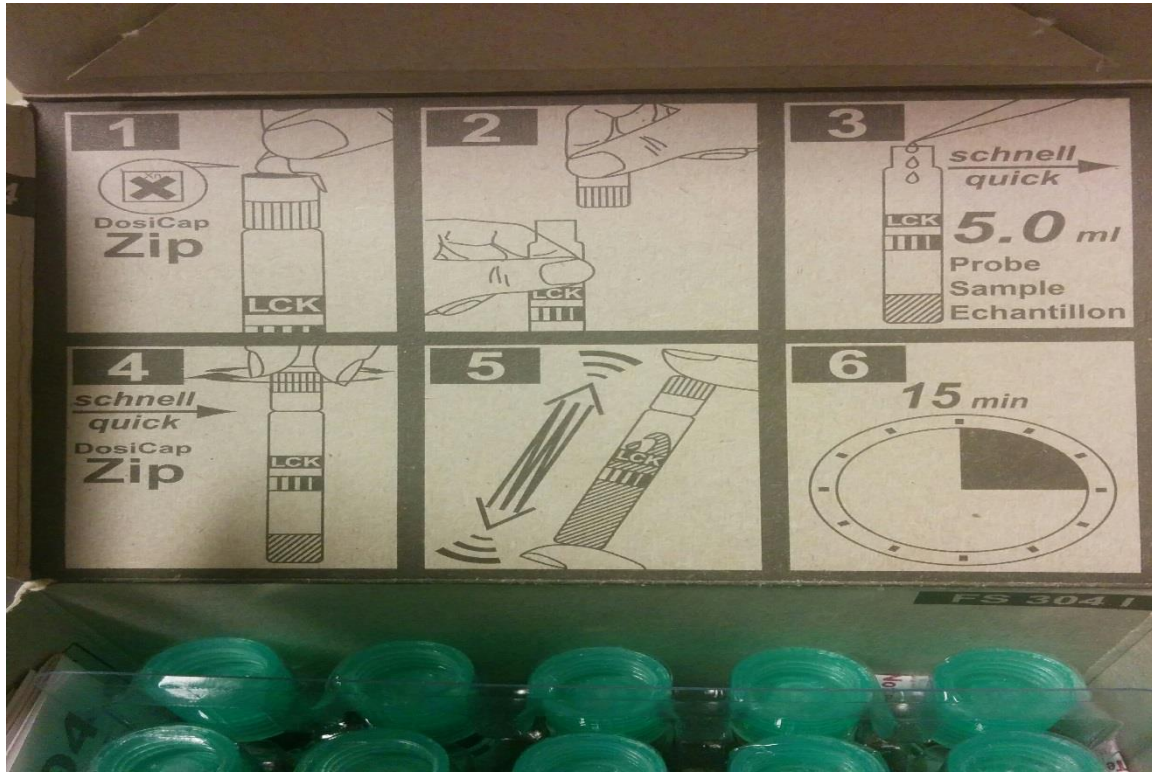
Figur 11: Figuren viser fremgangsmåte for ammonium forsøk.
