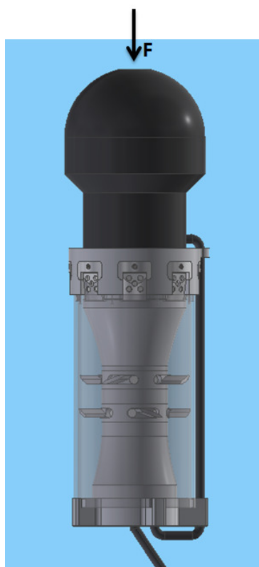
Figur 48 Testenhet og krefter i Z-aksen
