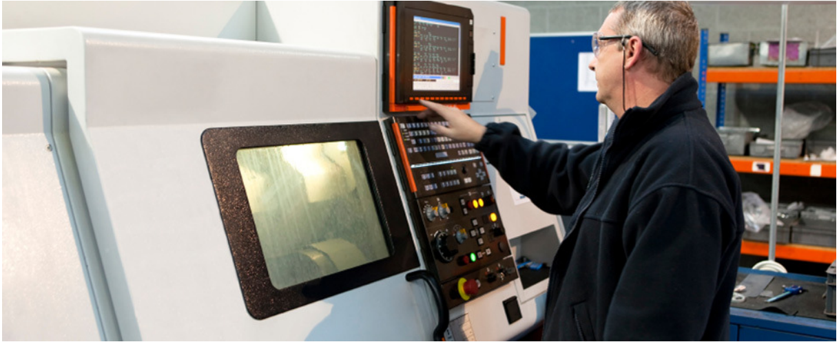
Figur 64 Programering av CNC-maskin (66)
