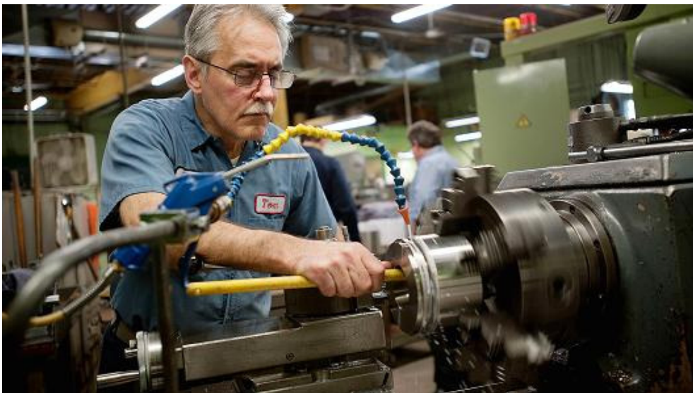
Figur 63 Dreining i en manuell dreiebenk (64)
