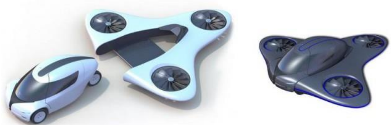
Figur 8.11: Skylys, viser hvordan det skal være mulig at bilen kjører ut av vingene (Mix Aerospace 2016).
