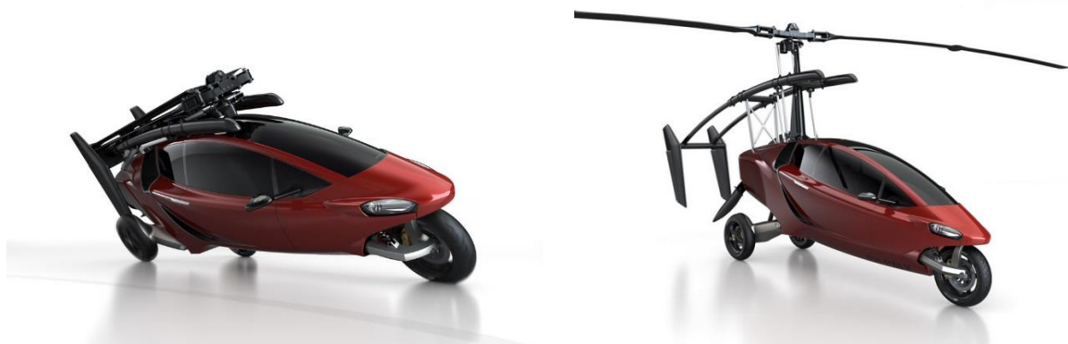
Figur 8.8: PAL-V, vist med sammenslått og utslått propellfunksjon (Pal-V 2016)
