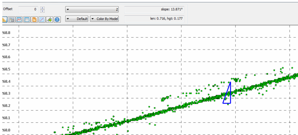
Figur 33: Veistrekning fra RPAS-basert laserskanning
