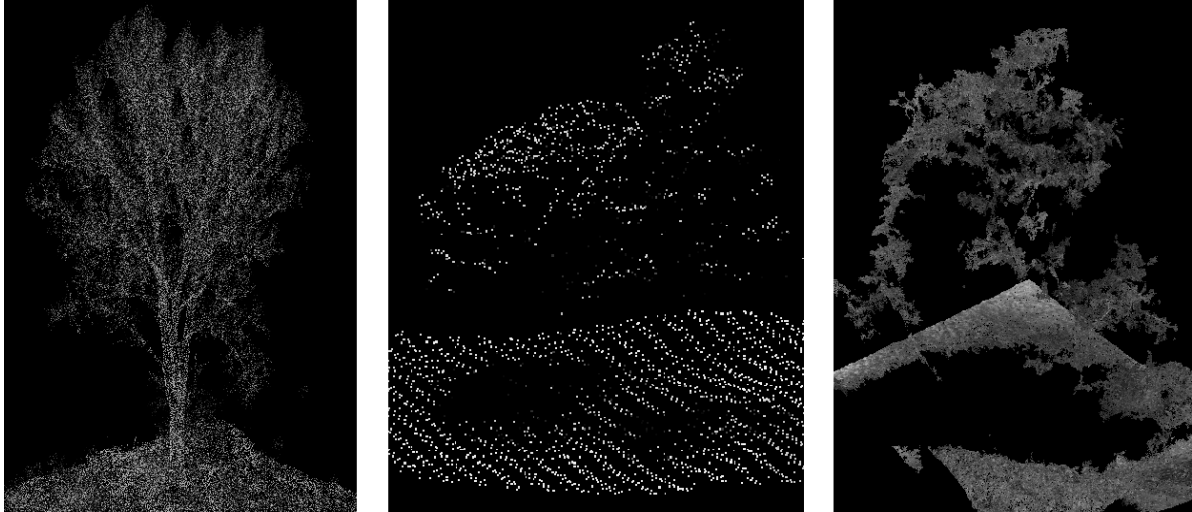
Figur 38: Forskjellen i detaljnivå, med RPAS-basert laserskanner(t.v.), flybasert laserskanning(m) og fotogrammetri(t.h.)
