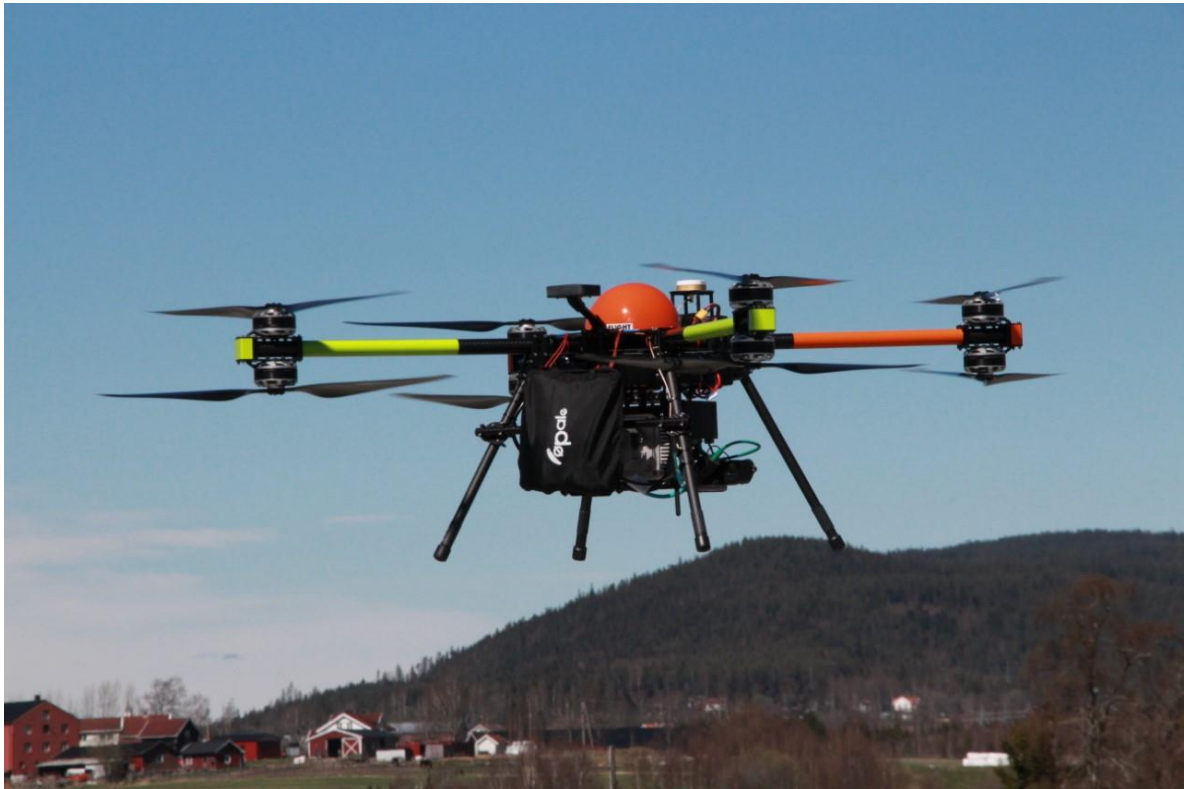
Figur 6: Prøveflyging med Camflight X8 og VUX-1
