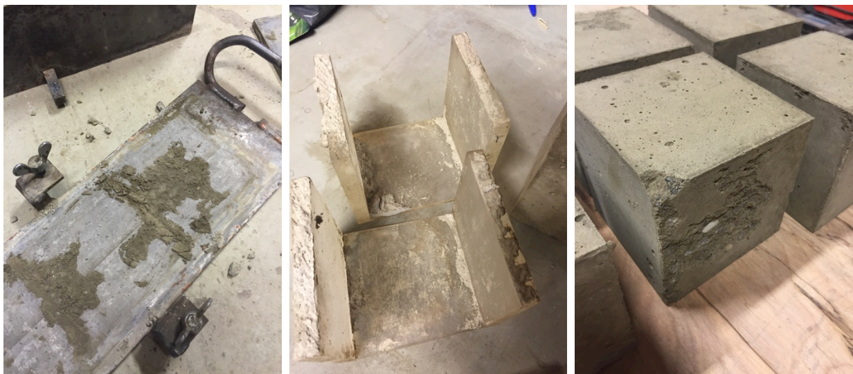
Figur 4.1 Pulverets størkningsretardende effekt på betong
