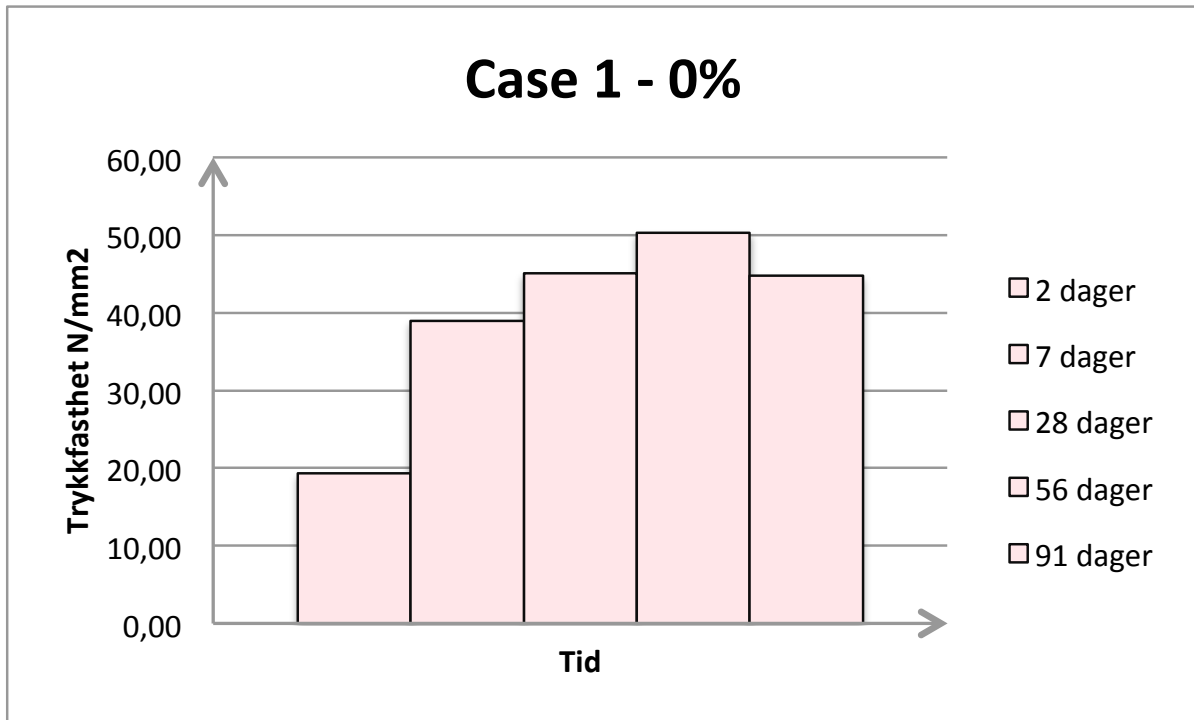
Figur 4.4 Ren B30 betong med 0% pulver og 100% sement
