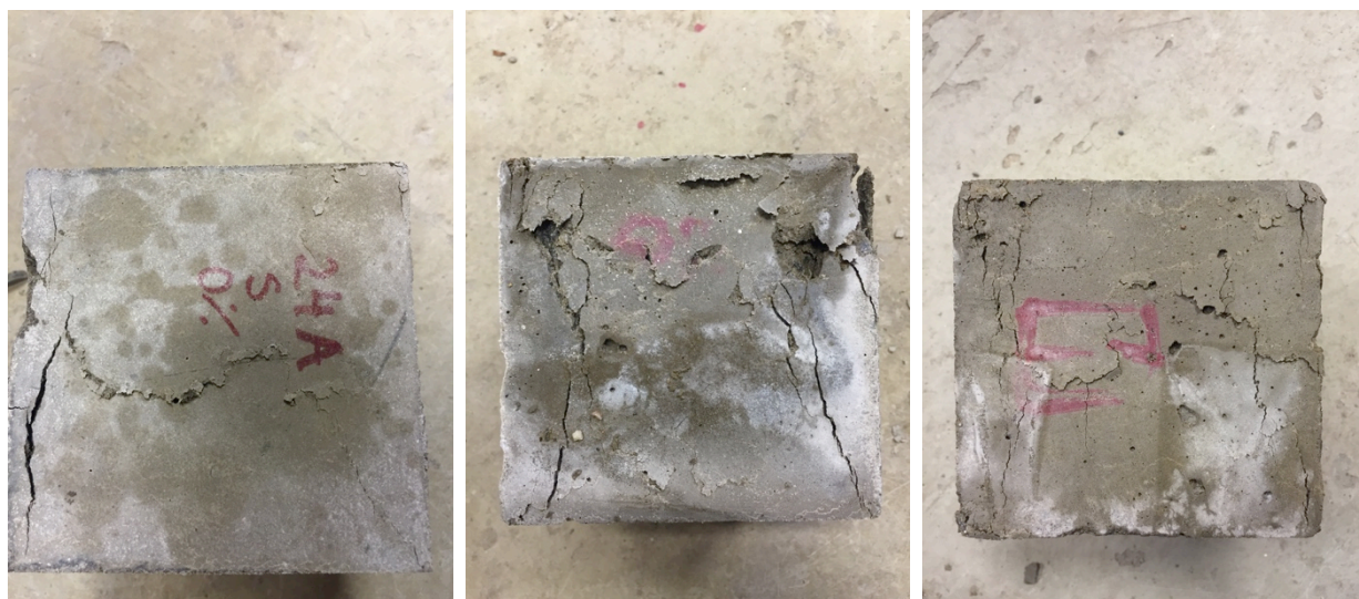
Figur 4.18 Trykte betongterninger – måling av trykkfasthet
