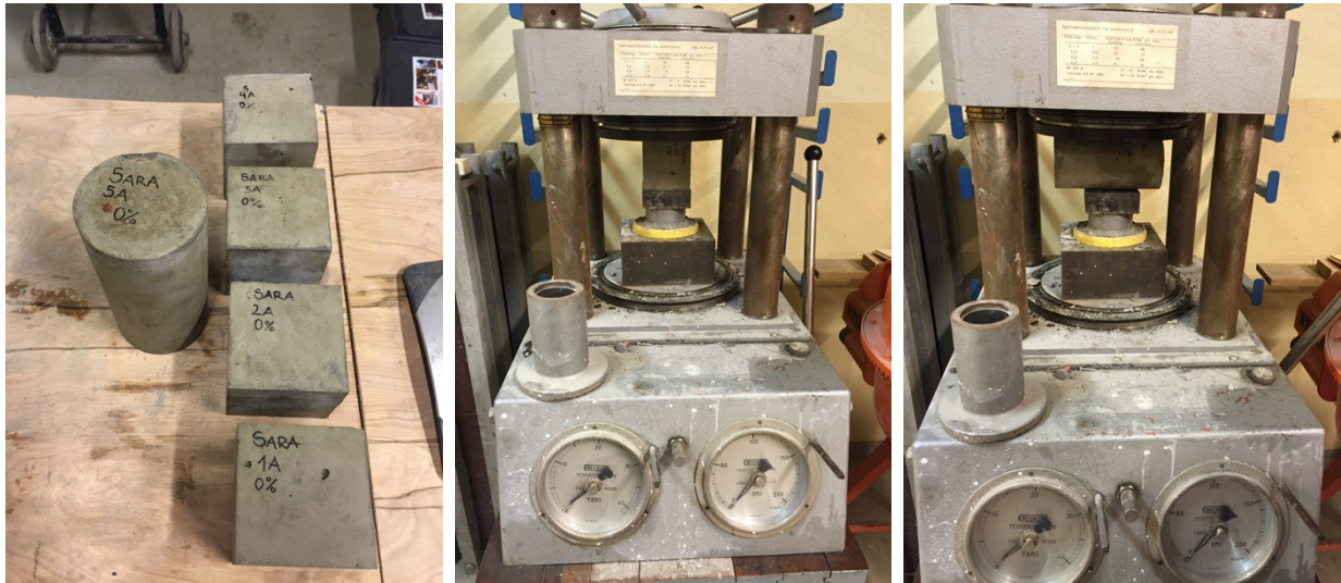
Figur 3.6(1) Terninger og sylinder tatt ut av vannbadet (2) trykkprøving av terning (3) trykkprøving av sylinder
