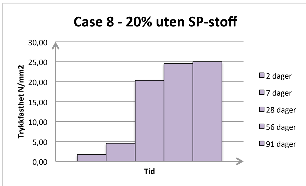
Figur 4.11 B30 betong med 20% pulver og 80% sement uten SP-stoff
