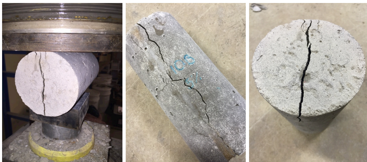
Figur 4.19 Trykte betongsylindere - måling av strekkfasthet
