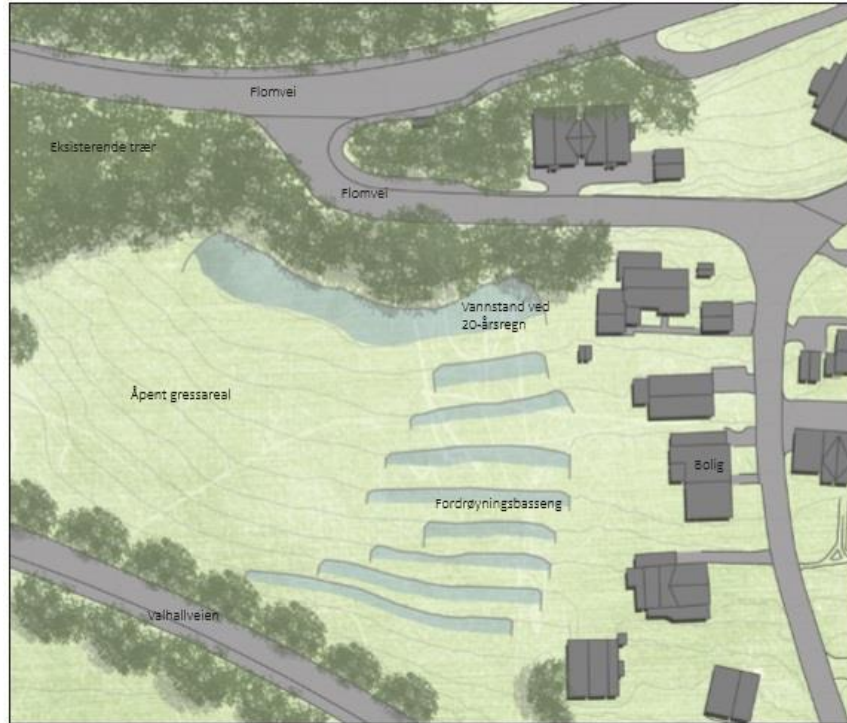
Figur 36: Fordrøyningsbassenger på østlig side av grøntarealet ved Valhallveien-svingen.
